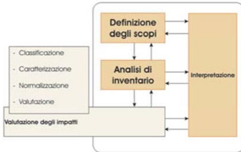
Figura 15 - Fase di Analisi di Impatto Ambientale di un'analisi LCA
