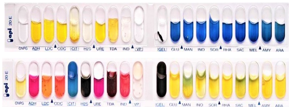
Figura 2. Galleria API 20 E. In alto test non seminato (tutte le reazioni sono negative), in basso un test di identificazione positiva.
