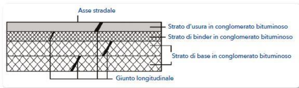
Figura 22 - Modalità di realizzazione dei giunti longitudinali
