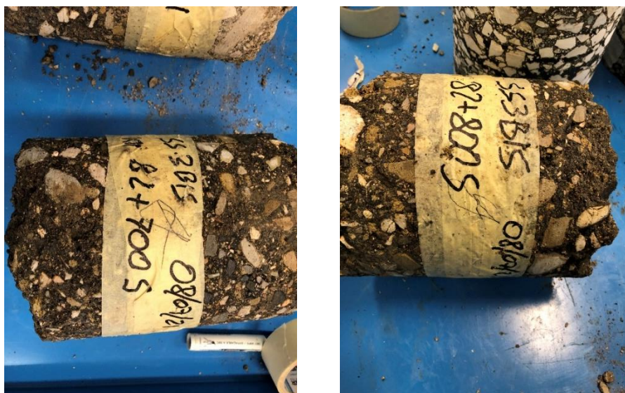
Figura 28 - Foto dei carotaggi della base a freddo al km 82+700 e 82+800
