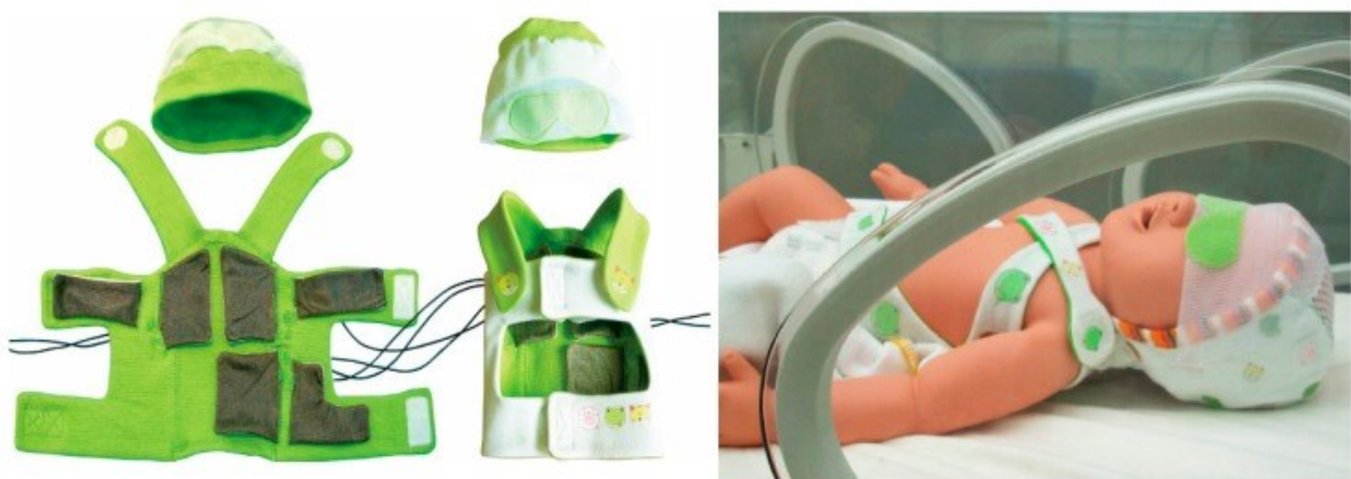
Figura 21 Esempio di sensori integrati su una giacca (smart jacket).
