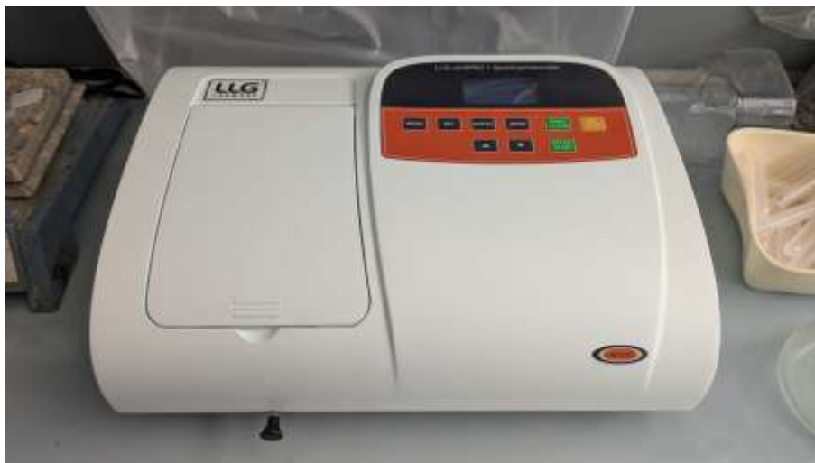
Figura 18: spettrofotometro UV/VIS per l'analisi del Fe^{3+} .
