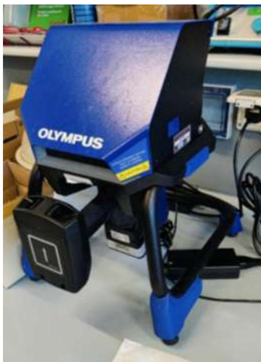
Figura 15: Foto dello strumento per l'analisi XRF.
