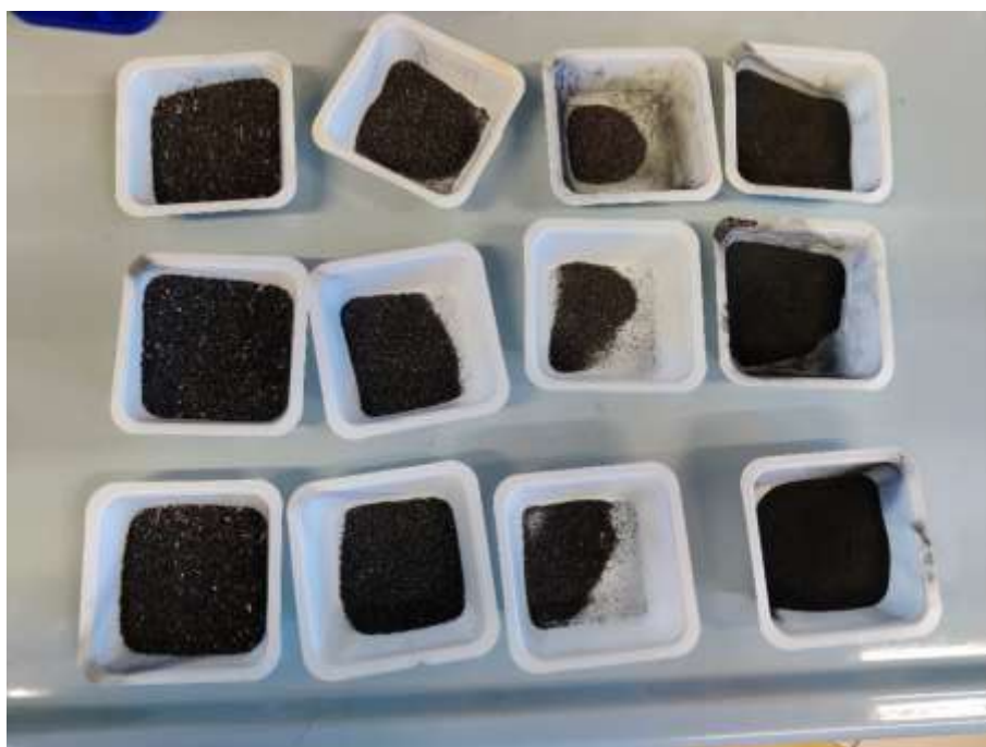
Figura 14: foto della suddivisione granulometrica dei tre campioni (A, B, C) di Black Mass delle batterie al litio.
