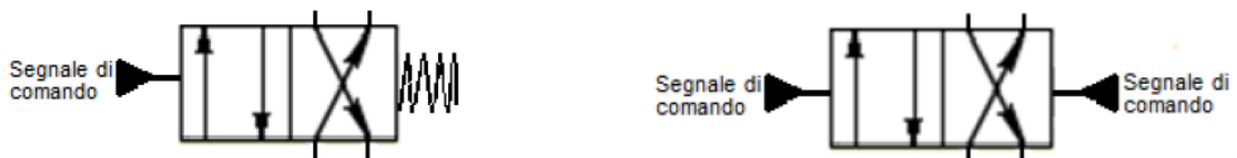
Figura 2.7: valvola monostabile con molla (a sinistra) e valvola bistabile (a destra).
