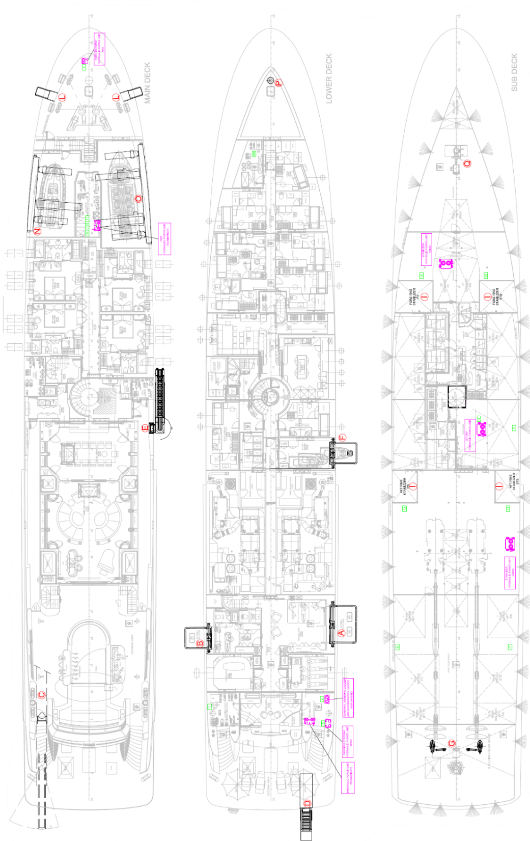
figura 4.12: layout generale del primo caso della disposizione delle centraline sui tre piani
