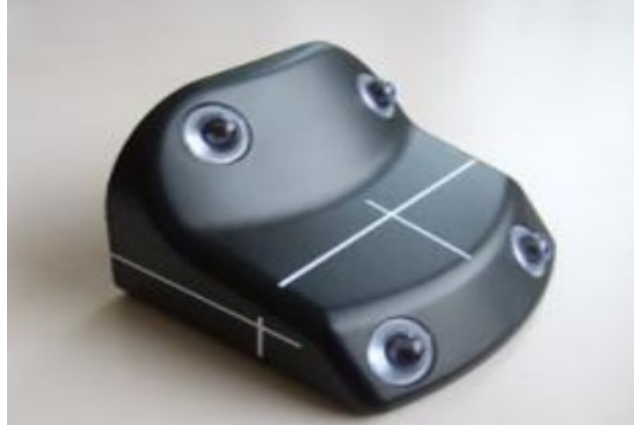
Figura 7 - Marker block con 4 marker riflettenti,
