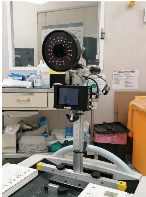
Figura 8 – Telecamera di localizzazione a infrarossi
