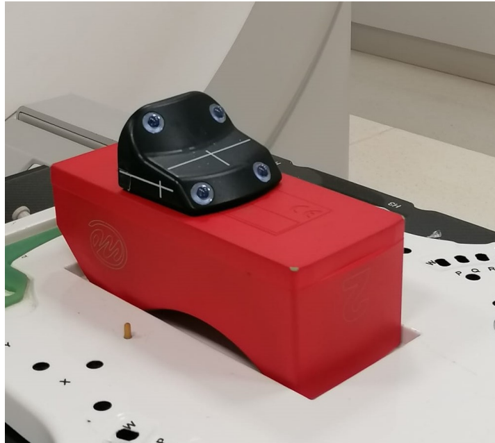
Figura 21 - Marker block in posizione per la calibrazione della telecamera sollevato 10 con un poggiatesta rovesciato
