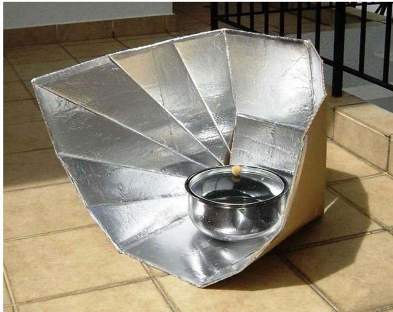
*Fig. 5 - Forno solare a pannelli [11]*
