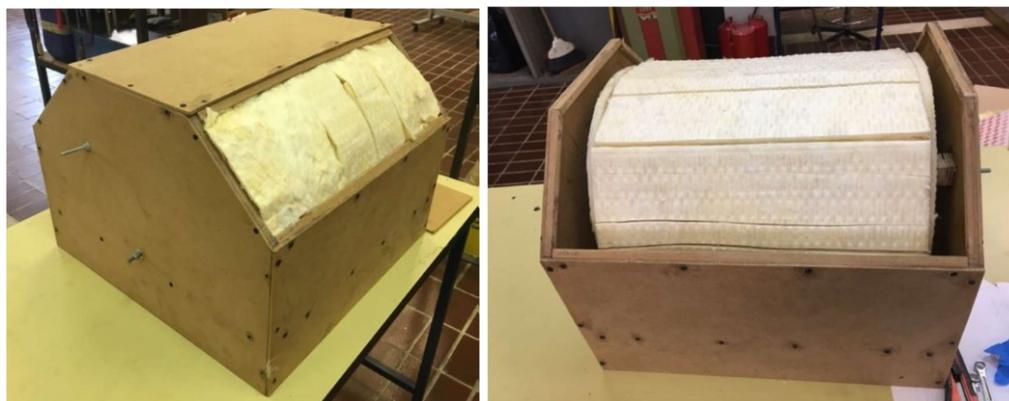
*Fig. 22 - Riempimento fessure con materiale isolante*
