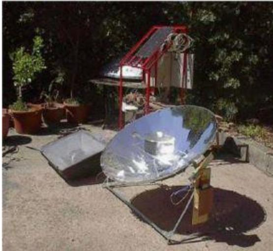
Fig. 8 - Forno solare parabolico integrato con pannelli fotovoltaici [13]
