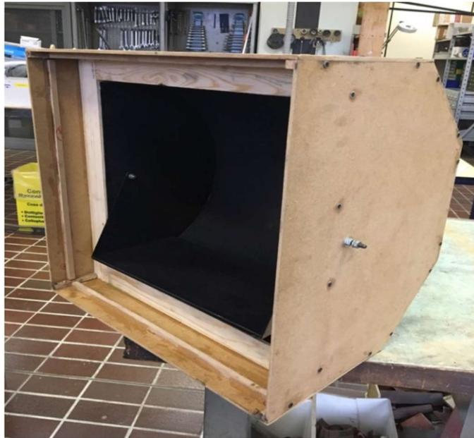
*Fig. 20 - Inserimento camera di cottura nell'involucro esterno*
