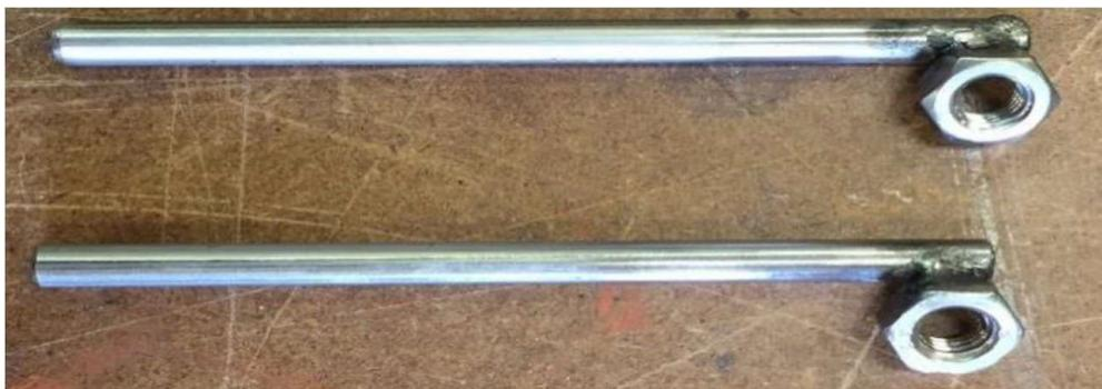
*Fig. 42 - Tubicini in acciaio INOX saldati ai bulloni*
