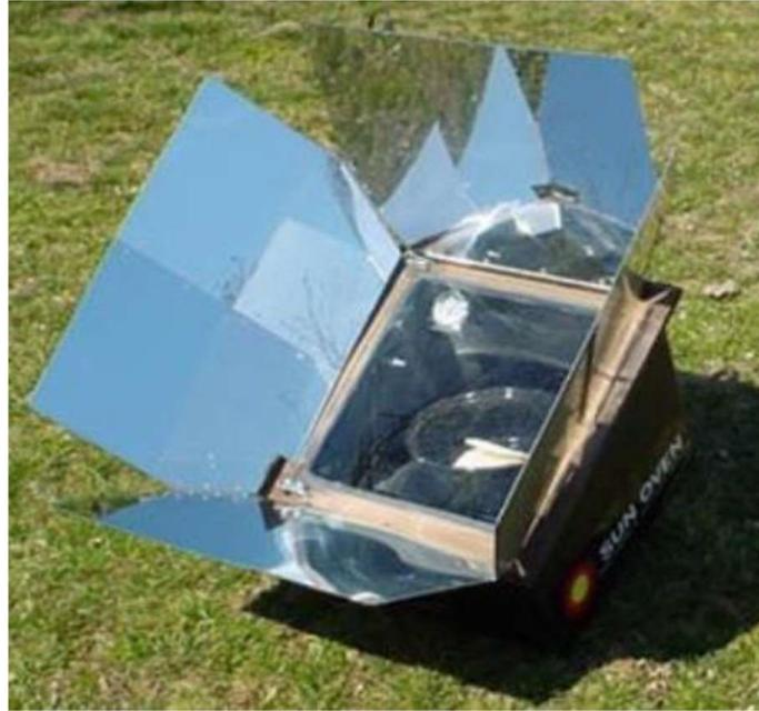
*Fig. 6 - Forno solare a scatola [12]*
