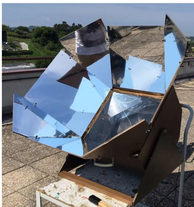
*Fig. 26 - Forno solare ultimato*
