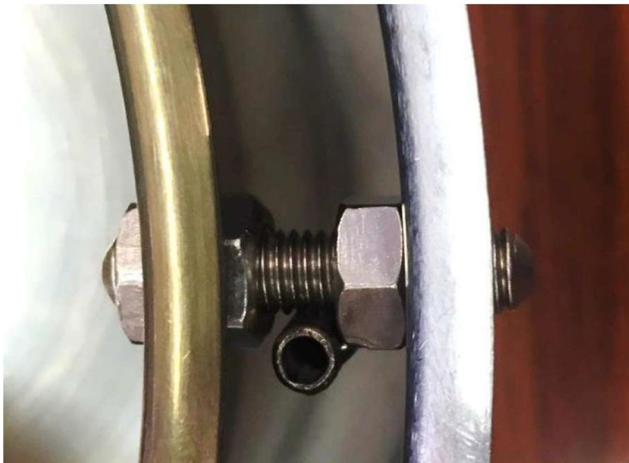
*Fig. 41 - Sistema di fissaggio delle pentole con tubicino in acciaio INOX per il passaggio delle termocoppie.*
