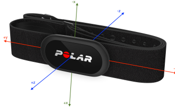
Figura 2.3: Polar H10 con rappresentazione degli assi
