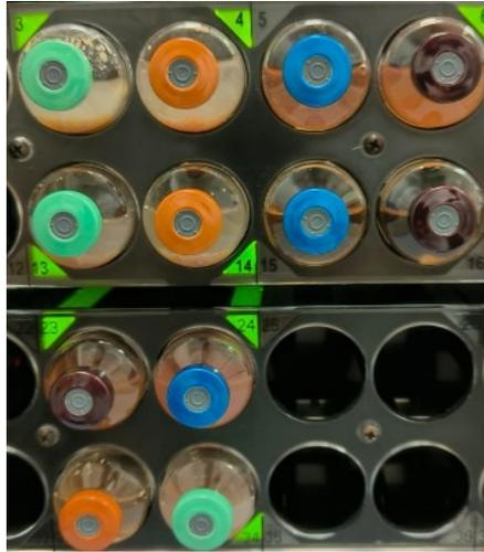
Figura 13. Allarme visivo di flaconi positivi: i numeri corrispondenti ai flaconi positizzati sono illuminati in verde.
