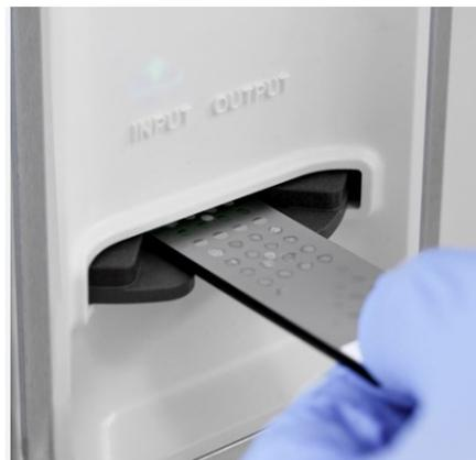
**Figura 20.** Ingresso della Piastra MALDI-TOF contenente all'interno dei pozzetti per le colonie da analizzare.
