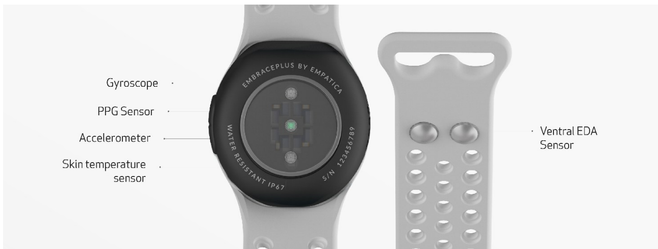
Figura 2 – Lato interno dell'EmbracePlus a contatto con la pelle
