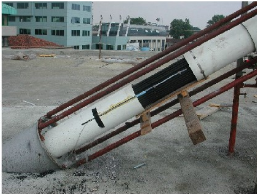
Figura 2.15 Disposizione dei sensori nello strallo
