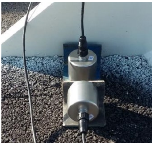
Figura 3.12 Due accelerometri PCB
