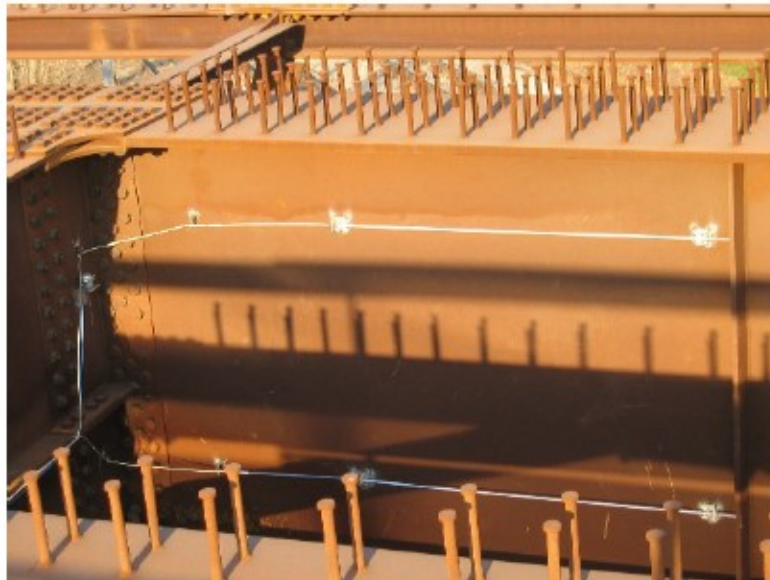
Figura 2.14 Disposizione dei sensori
