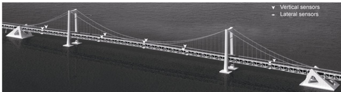
Figura 2.23 Posizione dei sensori con il metodo PSS-EI
