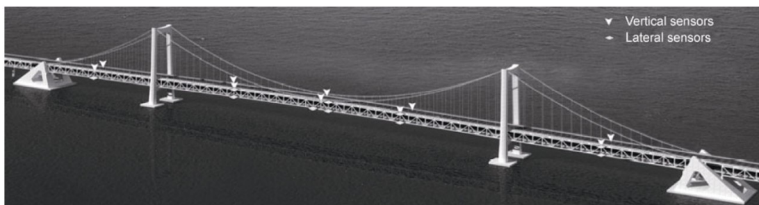
Figura 2.21 Posizione dei sensori con il metodo EI-DPR
