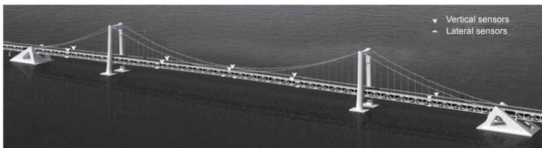
Figura 2.20 Posizione dei sensori con il metodo EI
