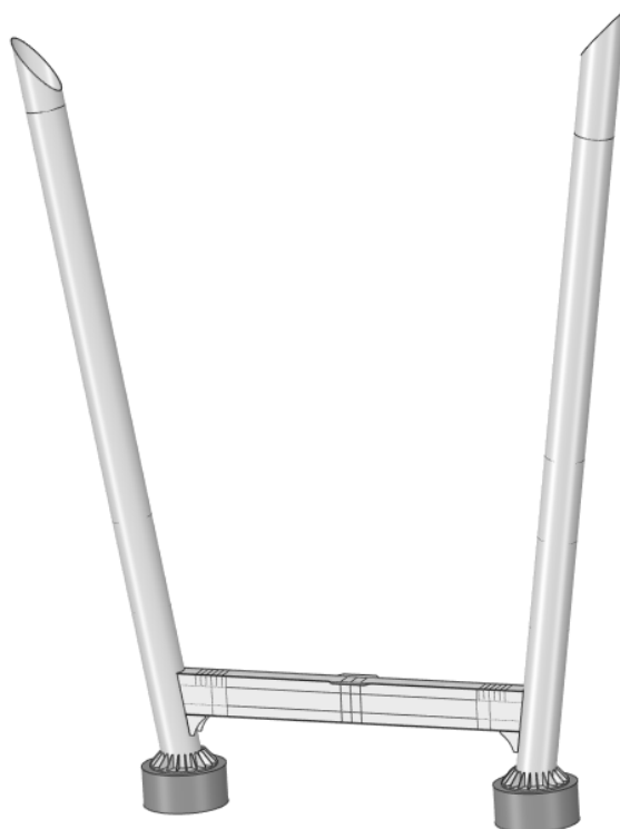
Figura 4.10 Modello solido del pilone
