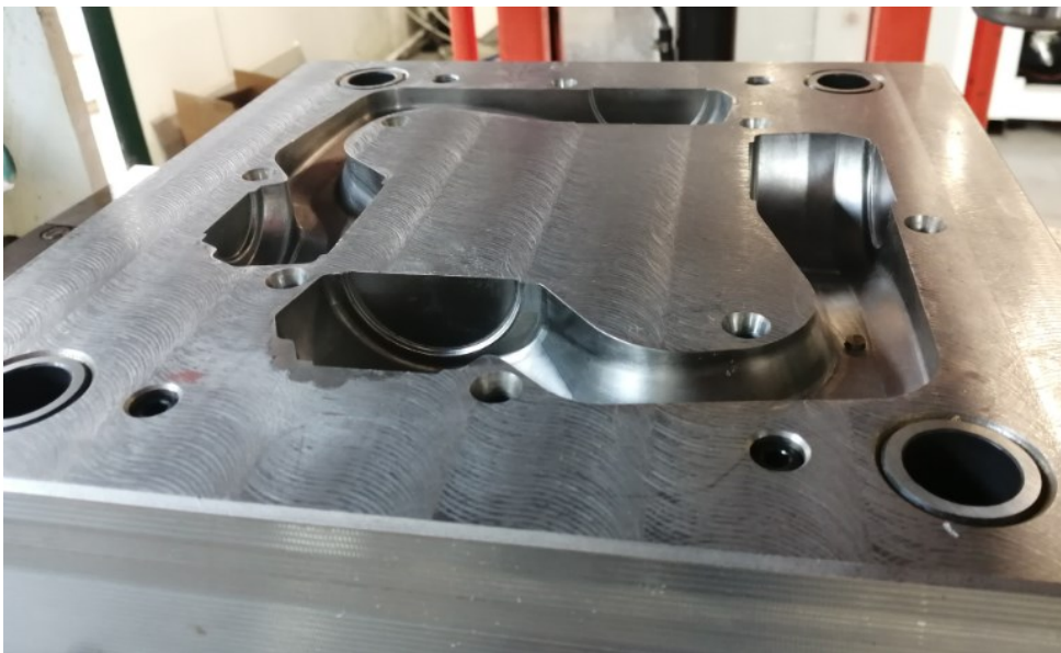
Figura 85 – Stampo in acciaio per la realizzazione del componente oggetto di studio di processo
