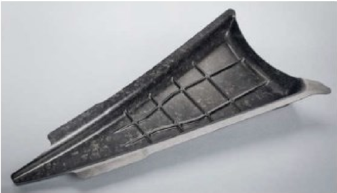
Figura 6 - Componente realizzato con la tecnica dello stampaggio a compressione.
