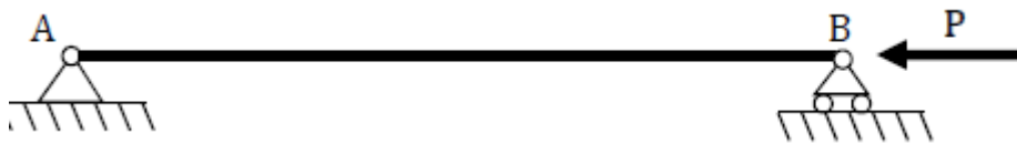
Figura 80 – Applicazione del carico di compressione all'asta.
