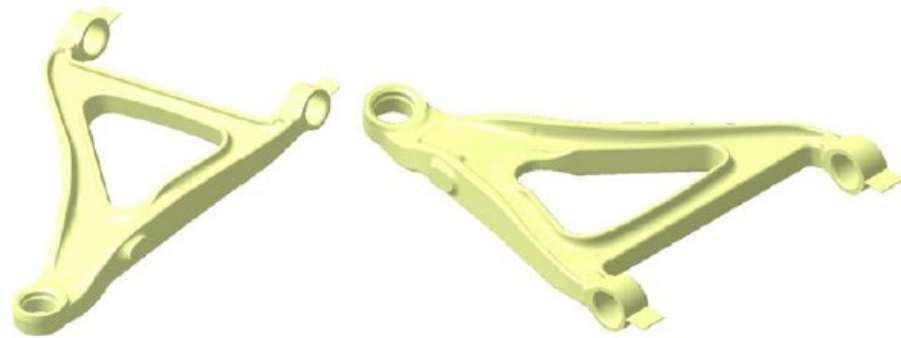
Figura 14 - Braccetto Inferiore Lamborghini realizzato col metodo Forged Composite®
