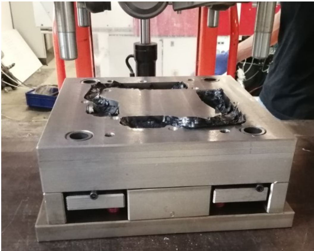
Figura 87 – Deposizione dei gusci preformati all'interno delle cavità dello stampo.
