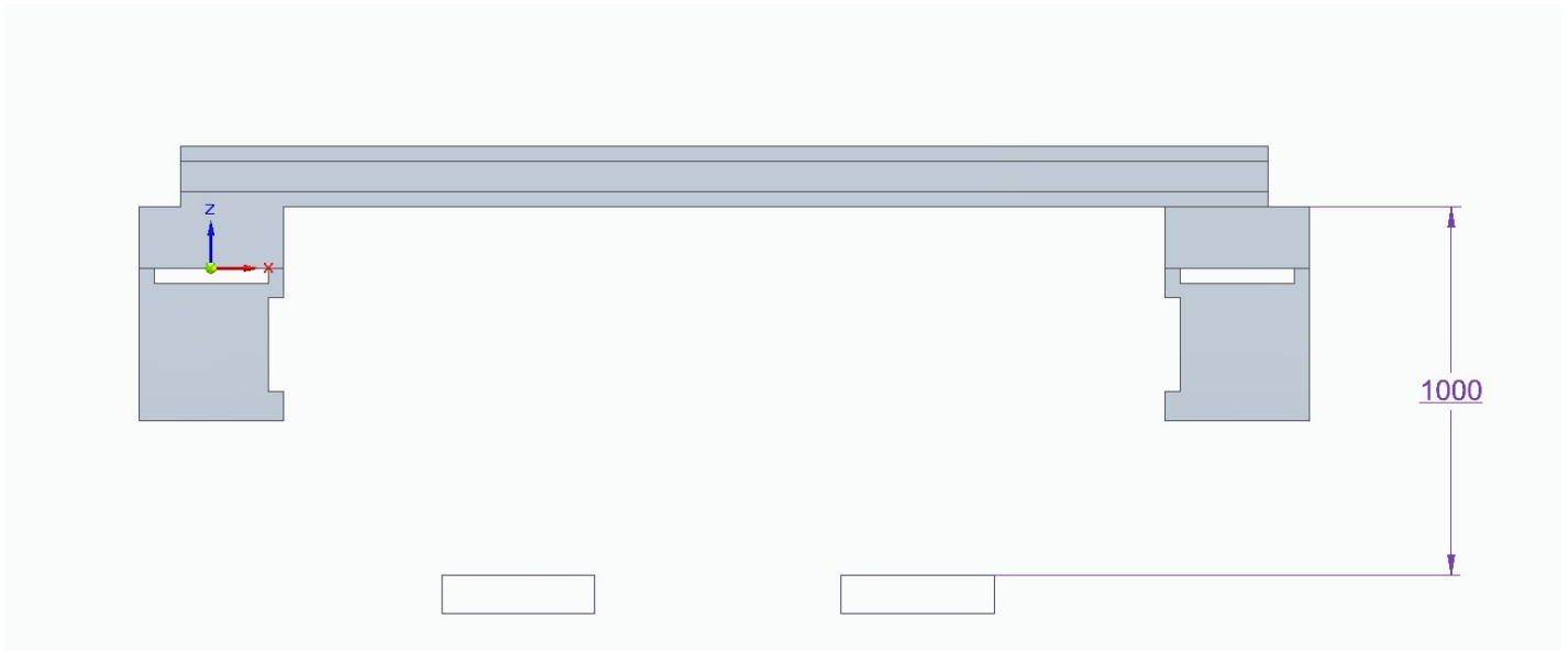
Figura 6: vista frontale dell'asse elettrico; la quota indica la distanza in millimetri fra il piano delle rulliere e l'asse trasversale.
