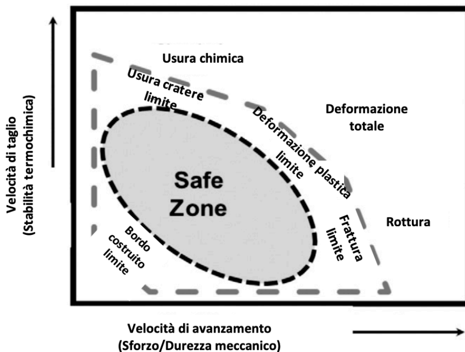
Figura 4 - Un diagramma della modalità di errore per un materiale utensile che incorpora un determinato materiale del pezzo e che mappa i meccanismi di usura come funzioni delle variabili di taglio dei metalli. La zona sicura definisce la regione operativa in cui lo strumento sopravvive in condizioni di usura prevedibili. (5)
