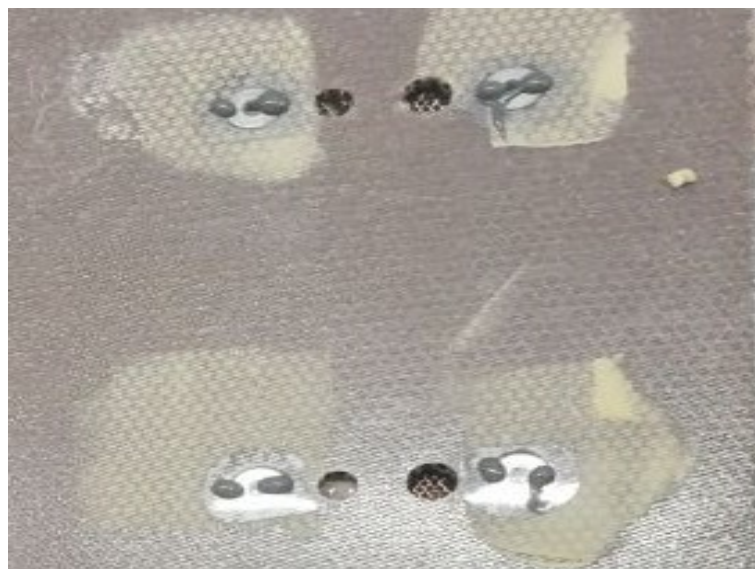
Figura 59 fase resinatura inserto
