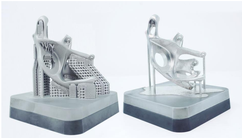
Figura 1: Rimozione della struttura di supporto.
