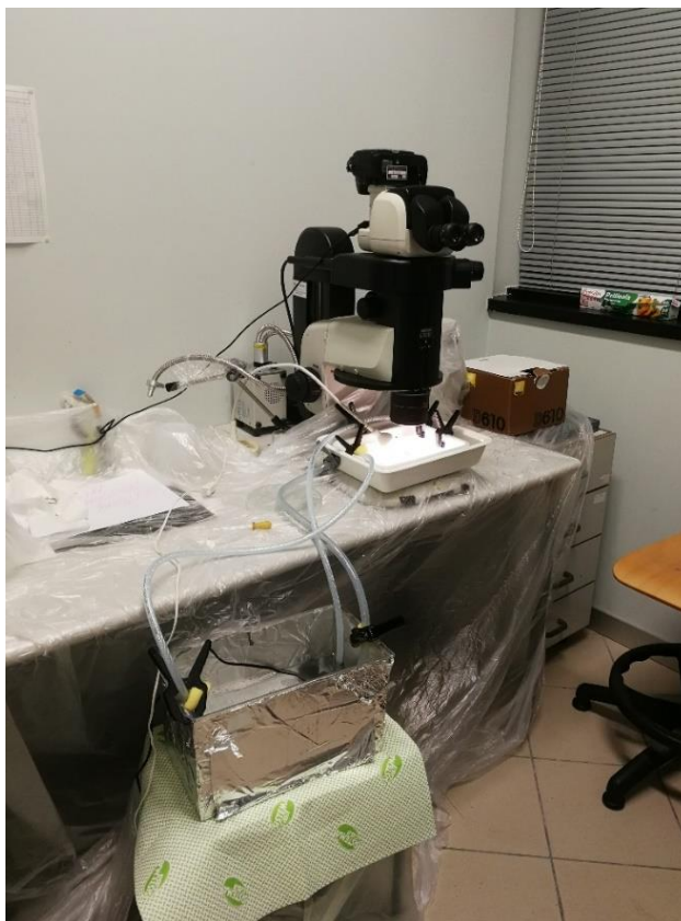
Figura3.4.2:sistema di ricircolo d'acqua con time lapse in funzione
