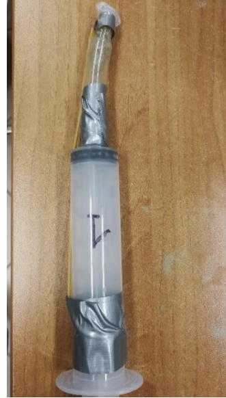
Figura 3.1.3: siringa da 20 ml per prelevare sedimento all'interno del corpo acquifero
