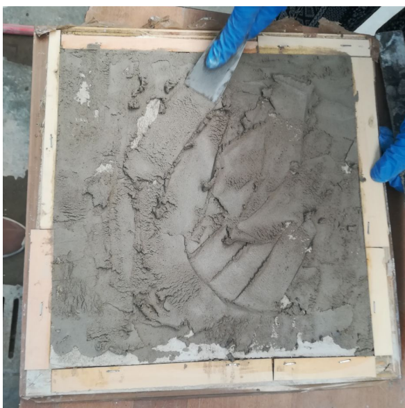
Figura 4.3.1-4.3.2: applicazione a spatola della finitura UNIVPM
