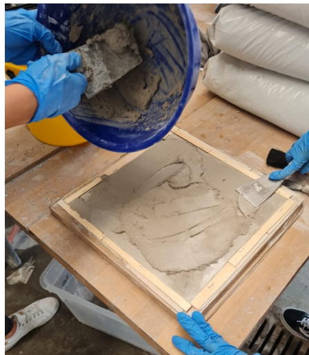
Figura 4.14: Stesura seconda mano di malta a spatola
