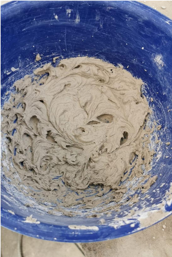
Figura 5.3: Consistenza del getto ALL dopo la miscelazione degli ingredienti
