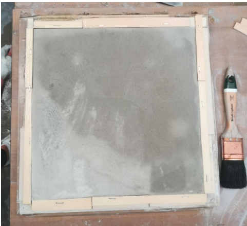
Figura 4.13: contornamento del getto con spondine di balsa per il controllo
