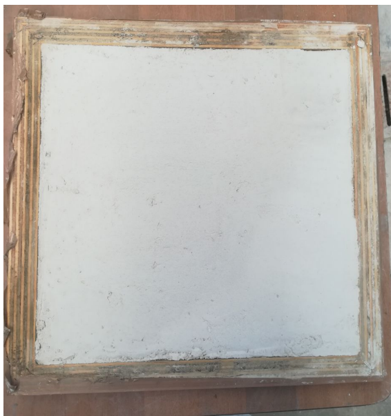
Figura 4.1: Sottofondo di calce storica
