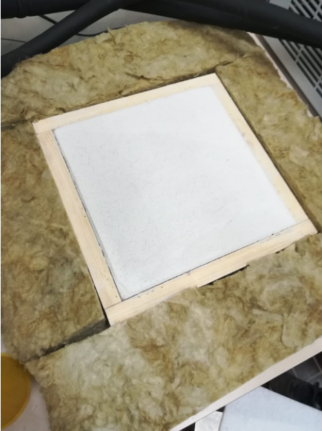
Figura 10.12: pannello rivestito esternamente con lana di roccia
