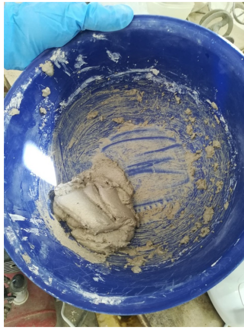
Figura 4.8.2: Impasto dopo l'aggiunta di acqua
