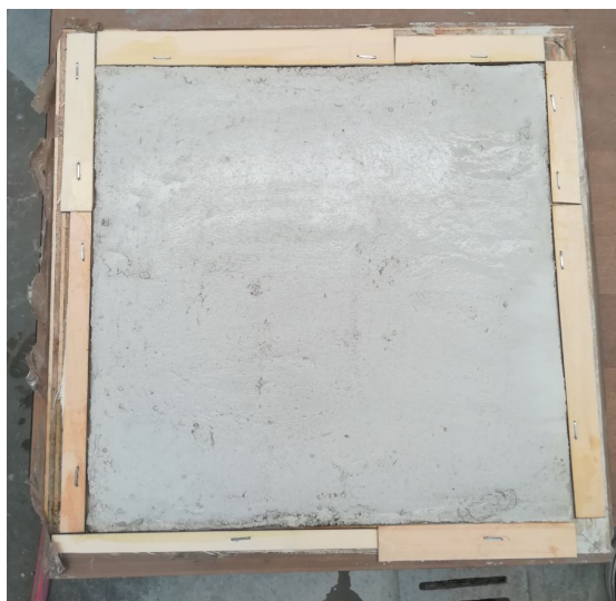
Figura 4.2: Applicazione delle spondine di balsa
