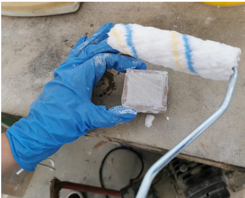
Figura 6.2: applicazione del fissativo mediante rullo
