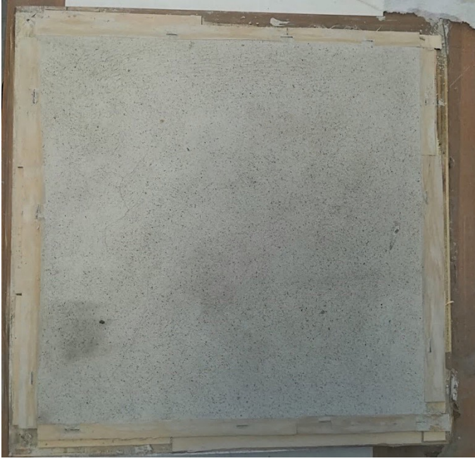
Figura 4.21: primi segni di fessurazioni sulla superficie del getto.
