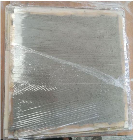
Figura 4.17: Superficie del getto priva di fessure dopo 1 ora dall'applicazione
