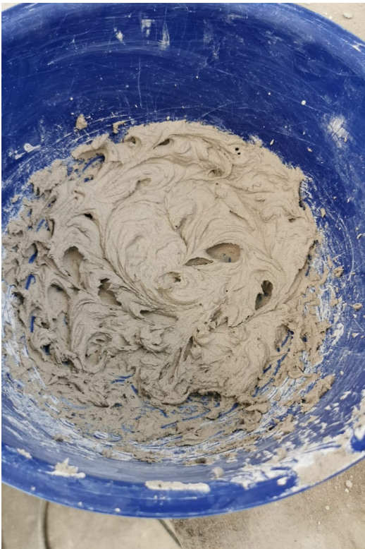
Figura 5.15: getto ARF dopo miscelazione.
