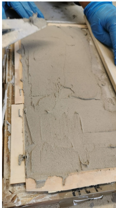
Figura 5.34: malta ACR prima dell'umidificazione
