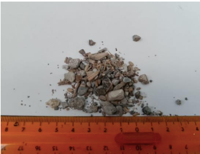
Figura 3.3: Trattenuto dalla setacciatura della Bottom Ash
