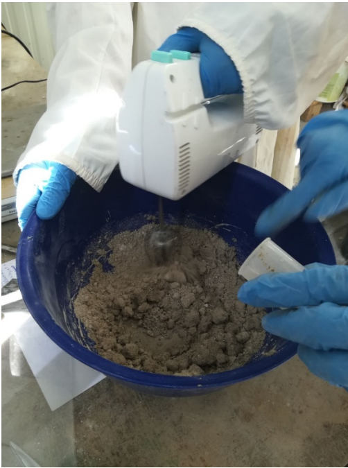
Figura 4.8.1: aggiunta di acqua durante il mescolamento dei materiali
