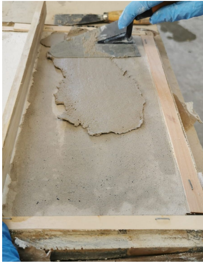
Fig. 5.39: applicazione a spatola del secondo strato di malta ARF
