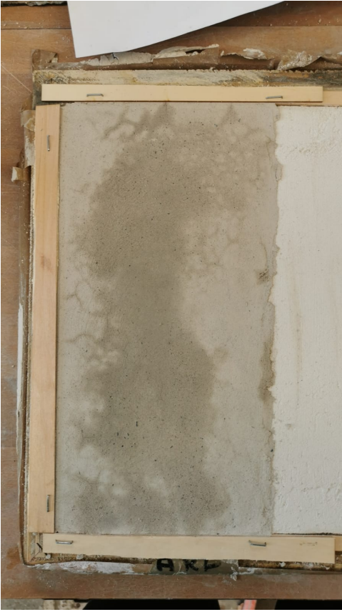
Figura 5.38: primo strato del getto ARF prima dell'applicazione della seconda mano, dettaglio della non uniformità della bagnatura
