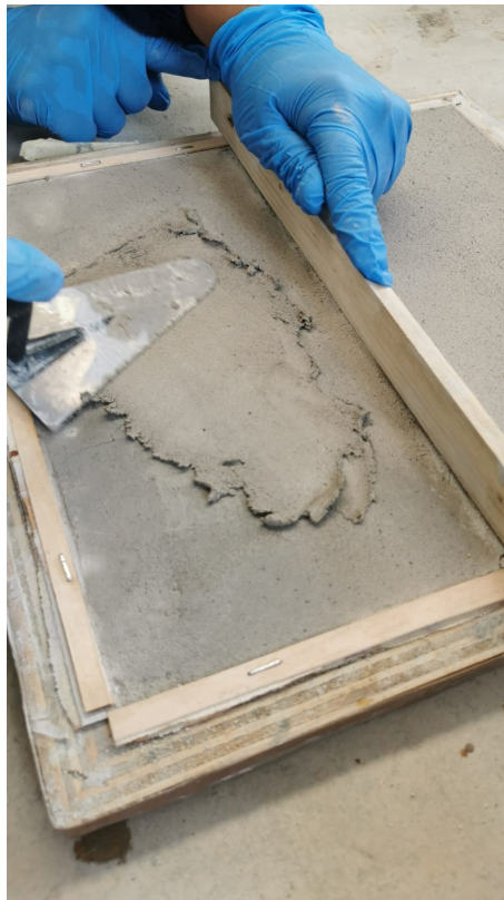
Figura 5.31: stesura a spatola seconda mano della malta A
