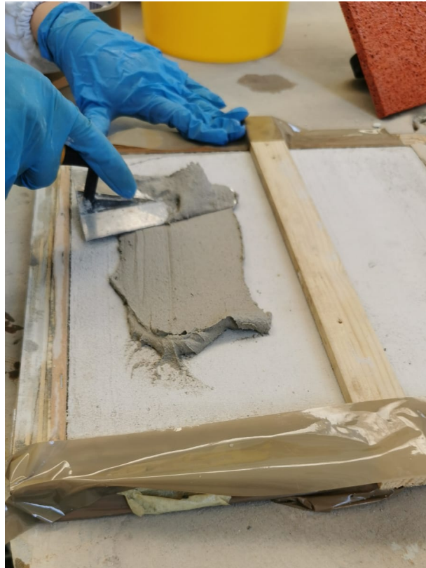
Figura 5.4: applicazione della malta mediante la spatola
