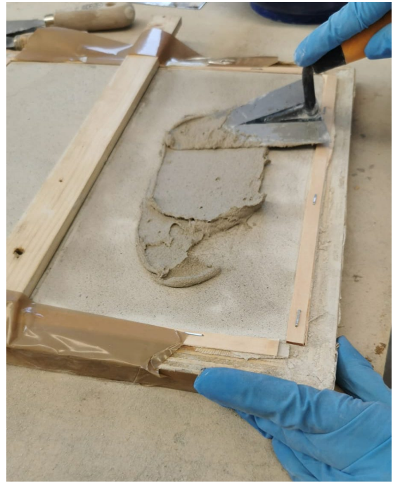
Figura 5.28: stesura a spatola getto ALL
