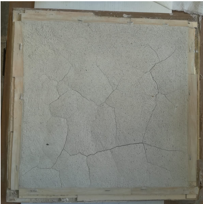
Figura 4.23: Superficie del getto 7 giorni dopo la stesura della seconda mano di malta.
