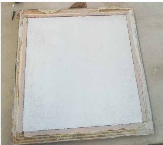
Figura 5.2: sottofondo di calce storica contornato con le spondine di balsa.
