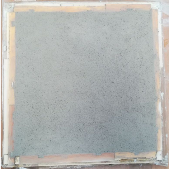
Figura 4.15: secondo strato di finitura precedentemente inumidito con le spugne ed il fratazzo
