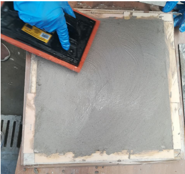
Figura 4.4: umidificazione del getto mediante il frattazzo
