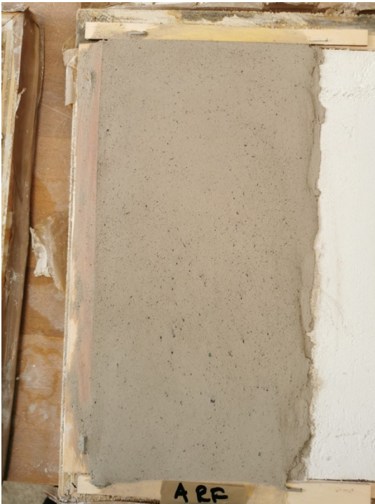
Figura 5.40: getto ARF spugnato. A destra dell'immagine dettaglio della difficoltà di stesura uniforme dalla malta
