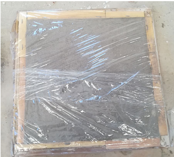
Figura 4.6: Copertura del getto con la pellicola
