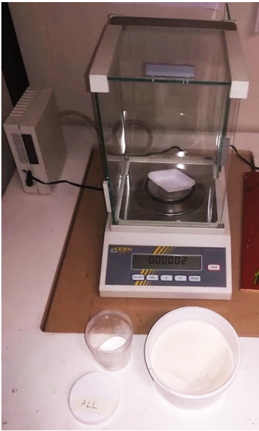
Figura 5.1: pesata degli additivi con bilancia analitica
