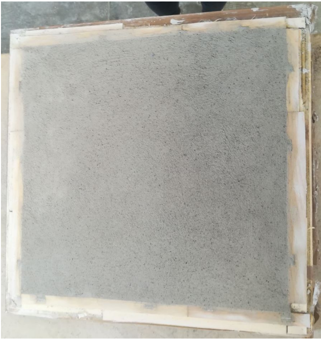
Figura 4.18: Getto dopo essere stato bagnato con le spugne ed il frattazzo
