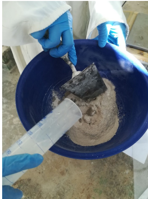
Figura 4.12: mescolamento degli ingredienti tramite cazzuola e aggiunta di acqua
