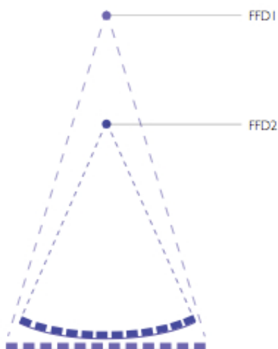
Fig. 5: la griglia antidiffusione si adatta alla distanza fuoco-detettore
