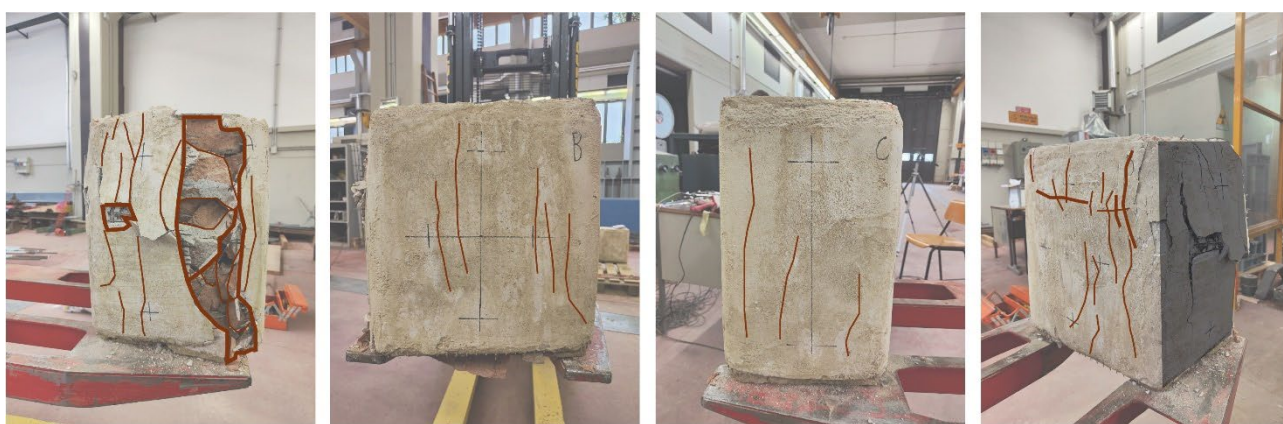
Figura 123_ formazione di fessure verticale e apertura del rinforzo (RT FRCM_2)
