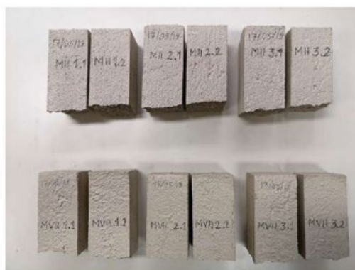
Figura 43_provini derivanti dalla prova a flessione
