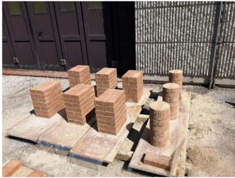
Figura 64_provini con giunti pieni (sx), provini con giunti scarniti (dx)
