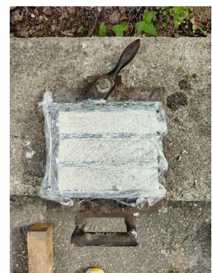
Figura 131_ disarmante (sx), riempimento dello stampo, posizionamento pellicola (dx)
