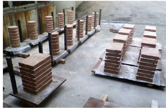
Figura 64_provini con giunti pieni (sx), provini con giunti scarniti (dx)
