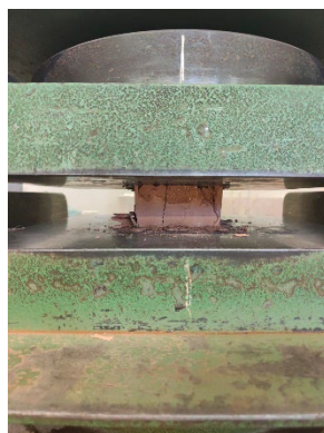
Figura 142_mattone compresso dopo la prova
