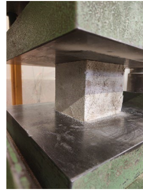
Figura 145_prova a compressione sui cubi di sacco
