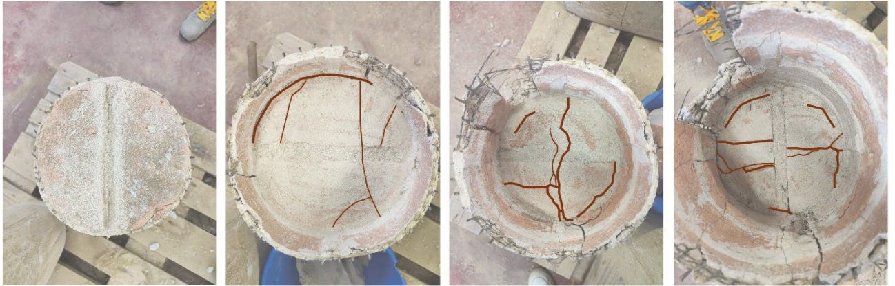
Figura 107_ formazione del nucleo compresso all'interno della sezione (filari 7, 6, 5, 4, CI FRCM_1)
