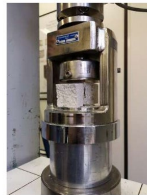
Figura 45_ prova a compressione dei provini di malta
