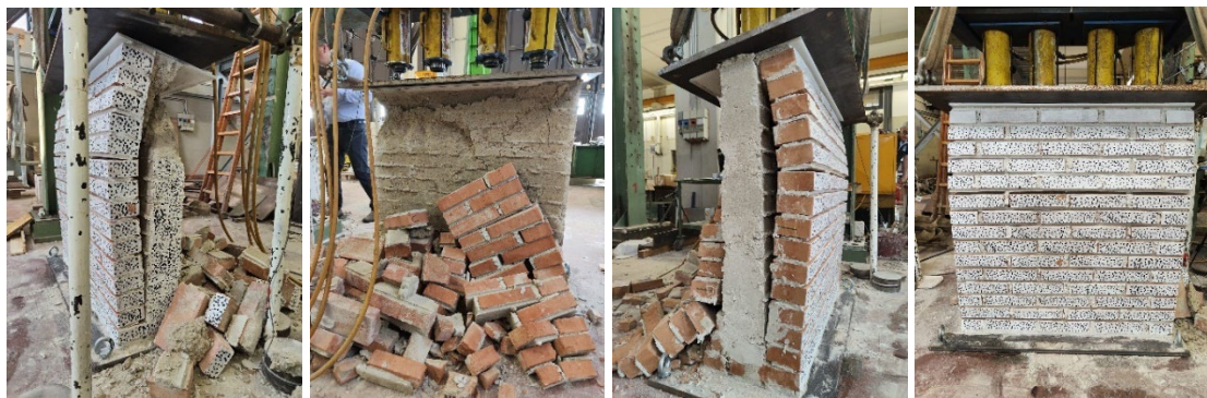
Figura 187_rilievo fotografico eseguito in seguito alla prova, facce A, B, C, D (MCS_3)
