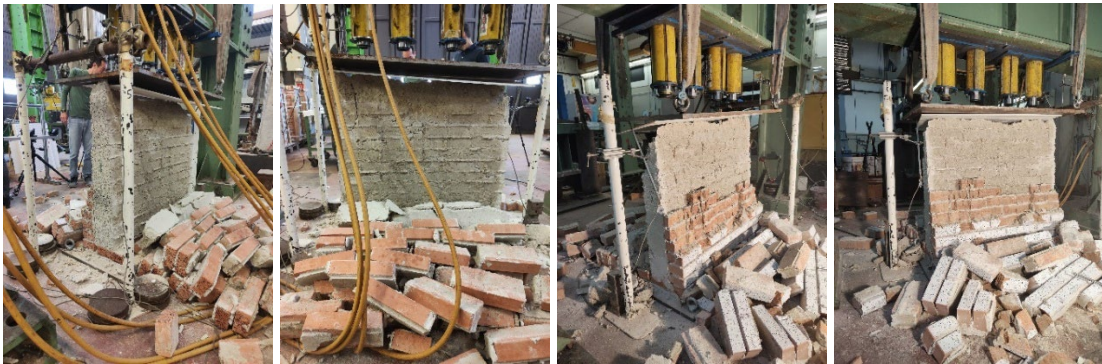
Figura 169_rilievo fotografico in seguito alla prova, facce A, B, C, D (MCS_1)
