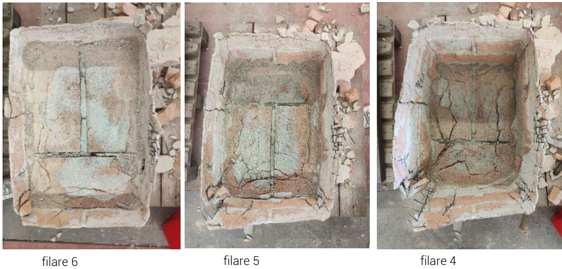
Figura 113_rilievo fotografico dei filari (RT FRCM_1)
