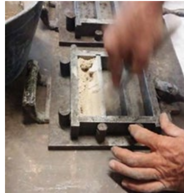
Figura 35_stampo oliato (sx), inserimento malta (dx)
