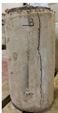
Figura 103_rilievo fotografico in seguito alla prova (CI FRCM_1)
