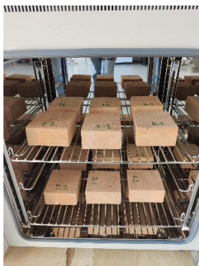
Figura 139_essiccazione dei mattoni in forno (sx) e misurazione del peso dei mattoni (dx)
