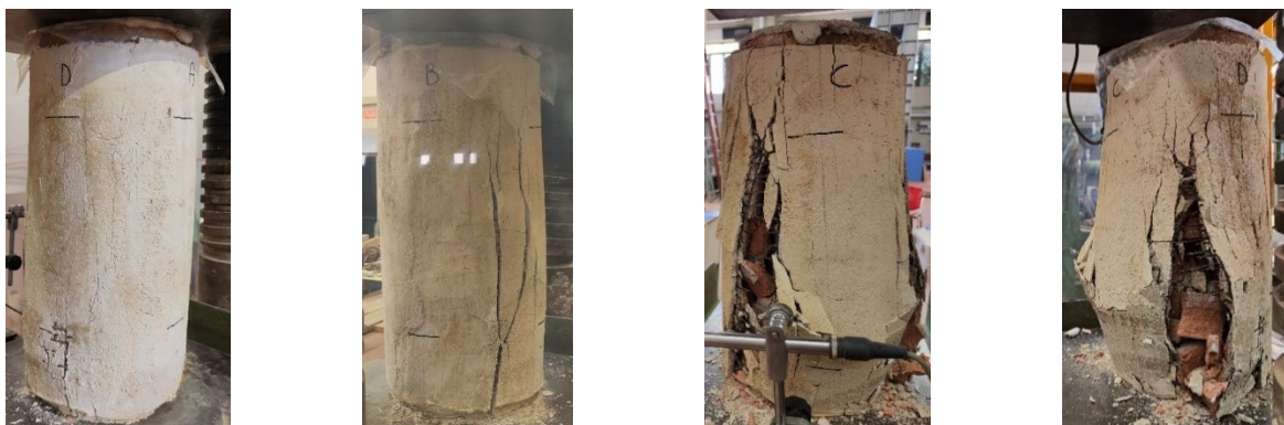
Figura 87_rilievo fotografico in seguito alla prova (CI FRCM_3)
