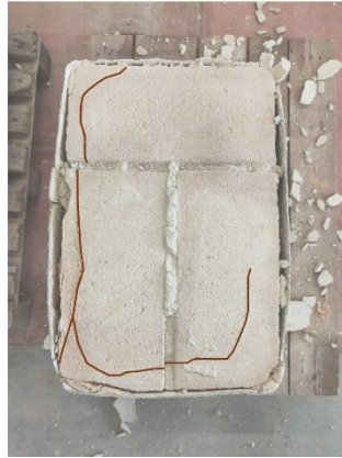
Figura 118_ formazione del nucleo compresso all'interno della sezione (filare 7, RT FRCM_1)
