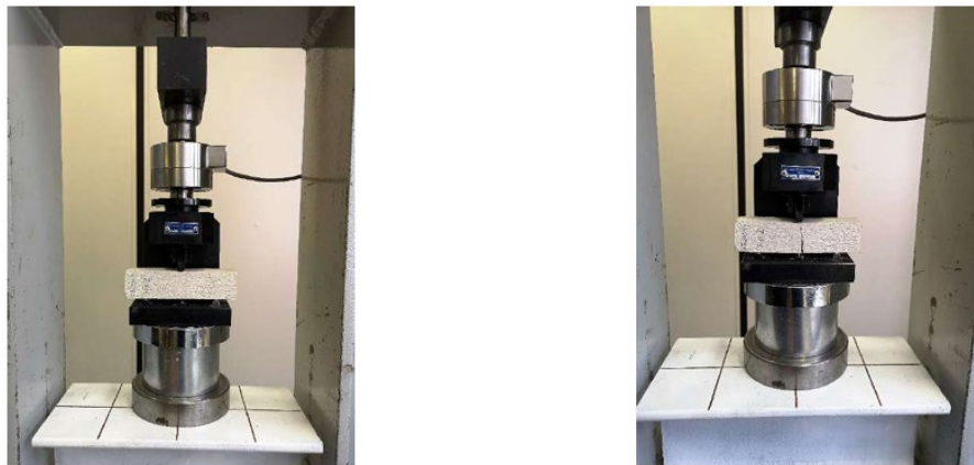
Figura 40_prova a flessione dei provini di malta
