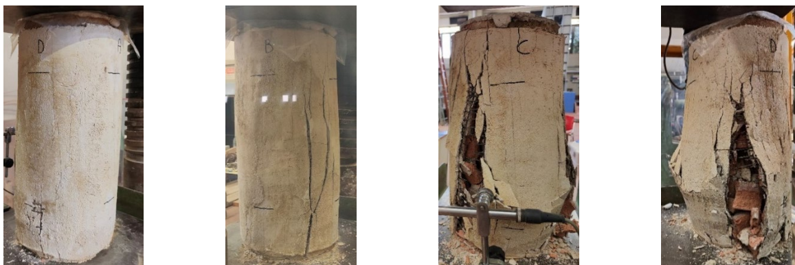
Figura 105_rilievo fotografico in seguito alla prova (CI FRCM_3)
