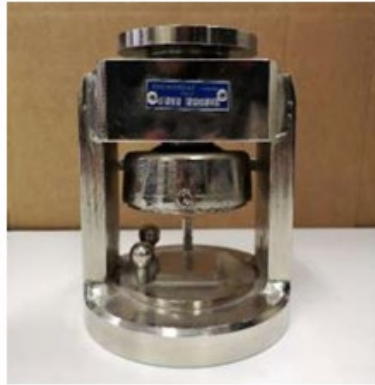
Figura 44_macchina adattata per la prova a compressione
