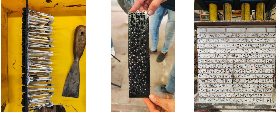
Figura 164_creazione dello stampo usato (sx e centro), configurazione di speckle finale (dx)
