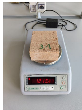
Figura 139_essiccazione dei mattoni in forno (sx) e misurazione del peso dei mattoni (dx)
