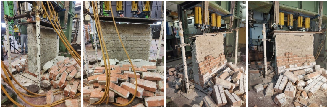
Figura 183_rilievo fotografico eseguito in seguito alla prova, facce A, B, C, D (MCS_1)
