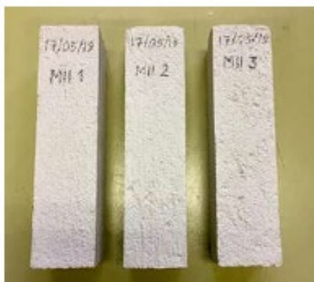
Figura 37_provini di malta
