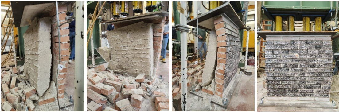
Figura 170_rilievo fotografico in seguito alla prova, facce A, B, C, D (MCS_2)
