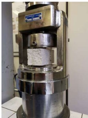
Figura 45_ prova a compressione dei provini di malta
