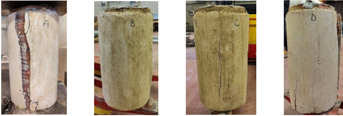
Figura 85_rilievo fotografico in seguito alla prova (CI FRCM_2)
