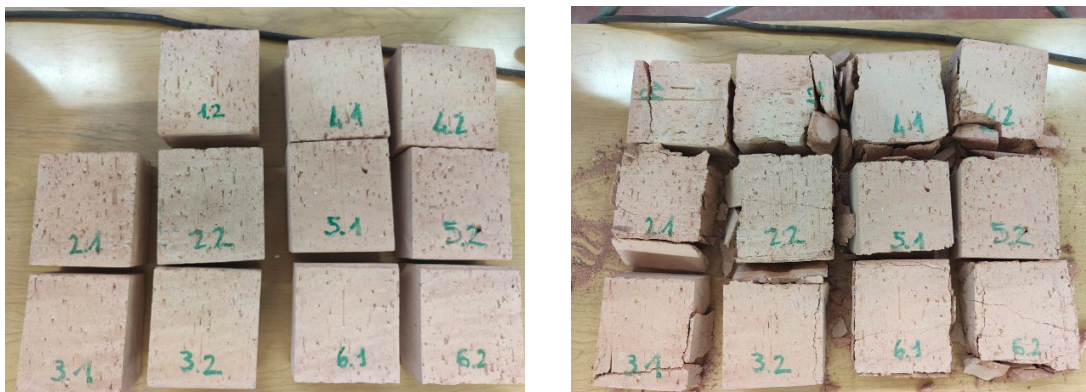
Figura 141_mattoni prima e dopo la prova
