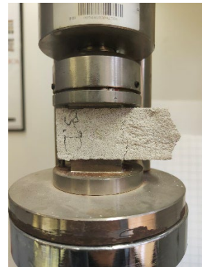
Figura 136_macchina per la prova a compressione (sx) e posizionamento del provino sotto la pressa (dx)
