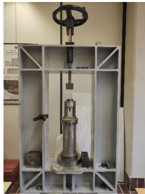
Figura 133_macchina per la prova a flessione su tre punti
