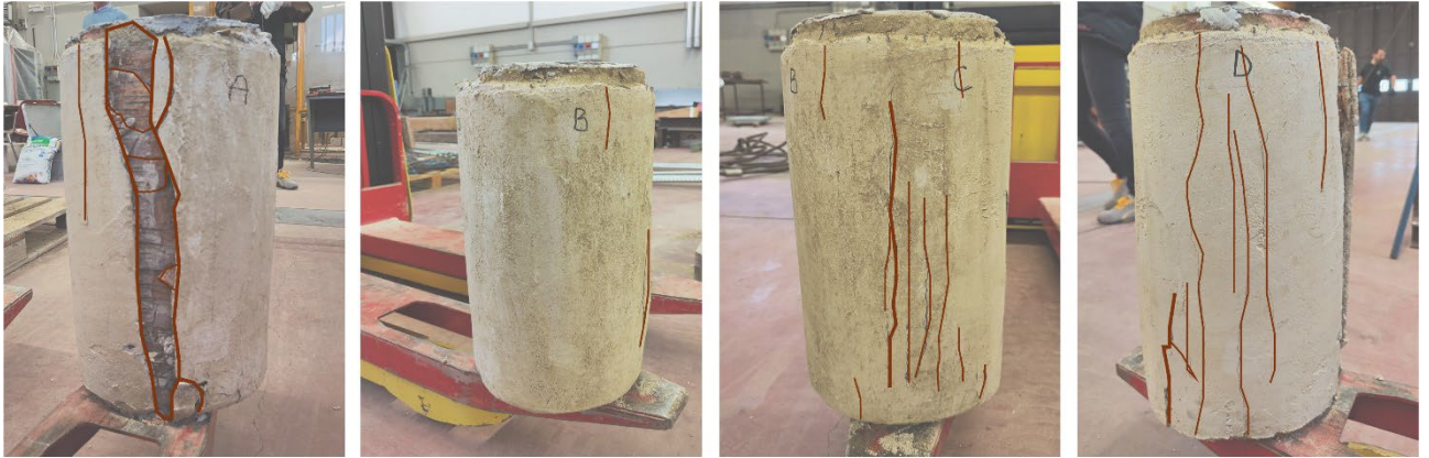
Figura 111_ formazione di fessure verticale e apertura del rinforzo (CI FRCM_2)
