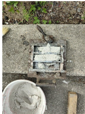
Figura 131_ disarmante (sx), riempimento dello stampo, posizionamento pellicola (dx)
