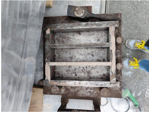
Figura 130_stampo (sx), spolvero e pulizia dello stampo (dx)
