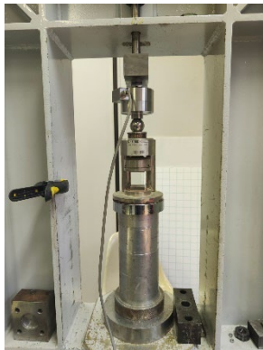
Figura 136_macchina per la prova a compressione (sx) e posizionamento del provino sotto la pressa (dx)
