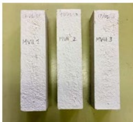
Figura 37_provini di malta
