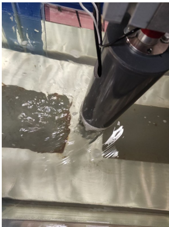
Fig. 6.3.d Vista dall'alto della nascita di vortici di scia e a ferro di cavallo in prossimità della pila
