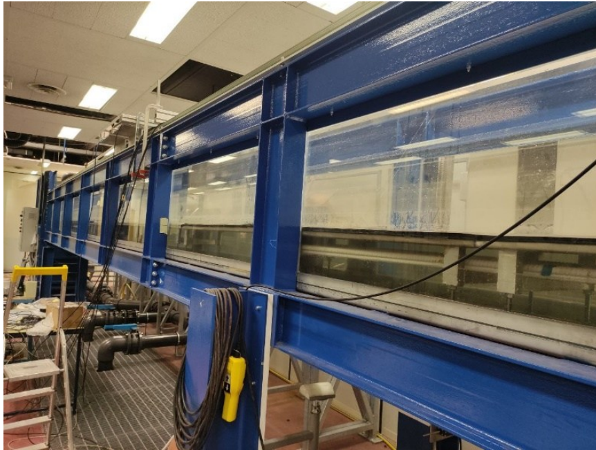
Fig. 6.1.a Canale Idraulico situato nel Laboratorio di Idraulica e Costruzioni Marittime dell'Università Politecnica delle Marche (vista valle – monte)
