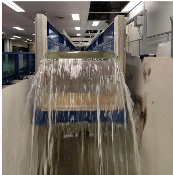
Fig. 6.3.g Vista dello sfioro a valle in presenza di una data portata
