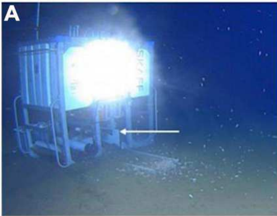
Hadal-lander per il campionamento di microplastiche nei fondali oceanici
