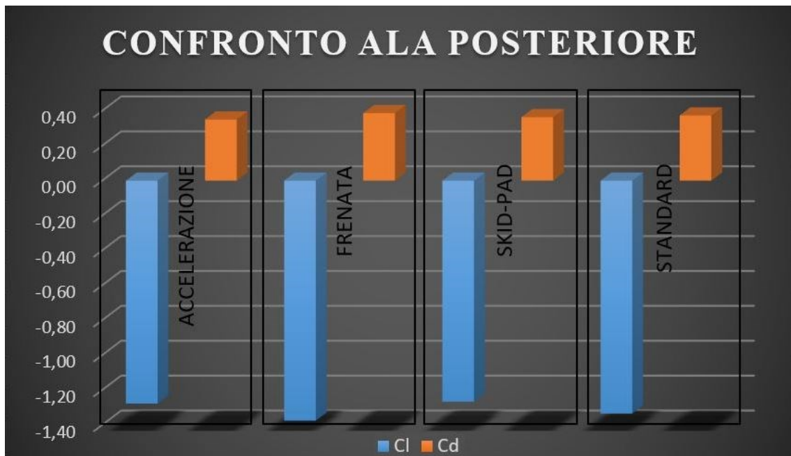
Figura 10.3: Andamento dei coefficienti aerodinamici nelle situazioni limite delle prove dinamiche.
