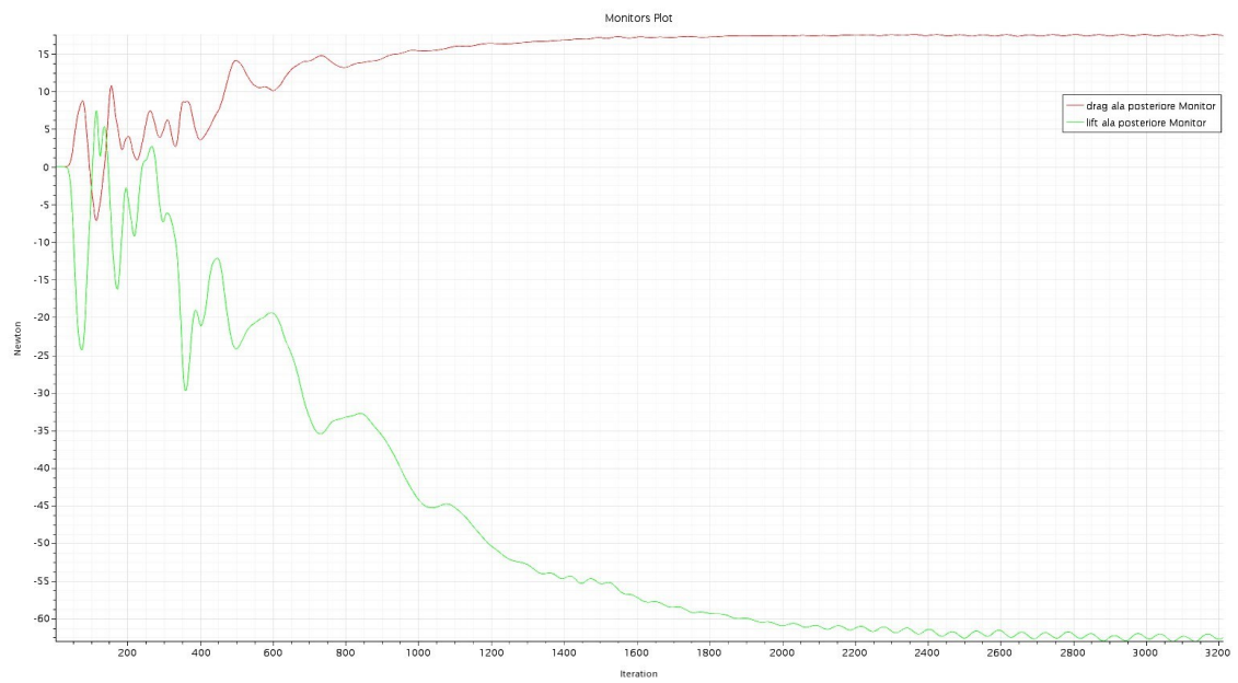
Figura 8.3: Andamento drag e lift ala posteriore.
