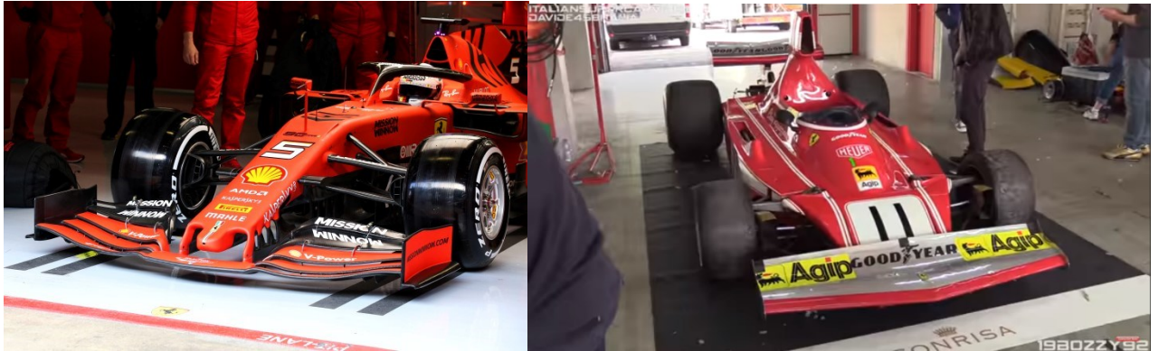
Figura 4.1: Confronto ala anteriore Ferrari SF90, Ferrari 312T.
