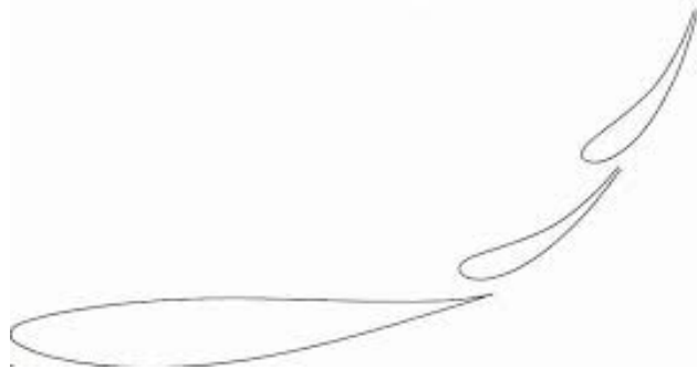
Figura 6.5: Sistema alare con flap.
