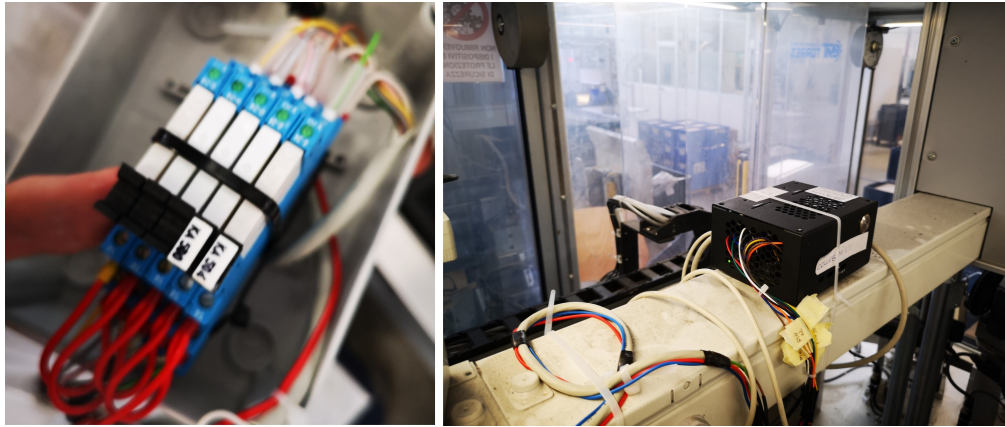
Figura 6.4: A sinistra si hanno i 5 relè utilizzati per l'interfaccia PLC-Jetson Nano. A destra la Jetson Nano nel suo case nero installata sulla linea automatica
