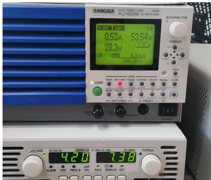
Figura 8.22: Prova di funzionamento della protezione dalle sovratensioni
