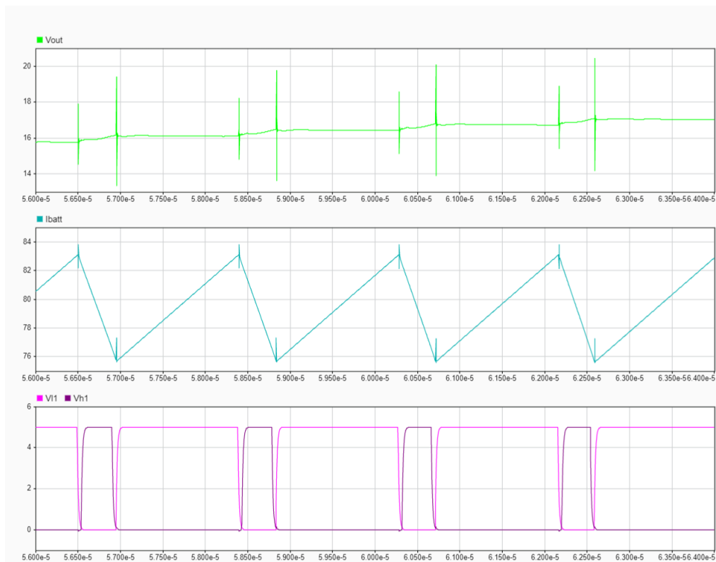
Figura 5.28: Plot reale Simulink - Ripple di V_{out} e I_{batt} alla commutazione
