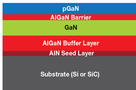
Figura 4.17: Uno strato aggiuntivo di GaN, drogato con impurità di tipo p, può essere aggiunto al processo di eteroepitassia durante la produzione di un dispositivo in modalità di potenziamento, come illustrato nella Figura 4.11.
