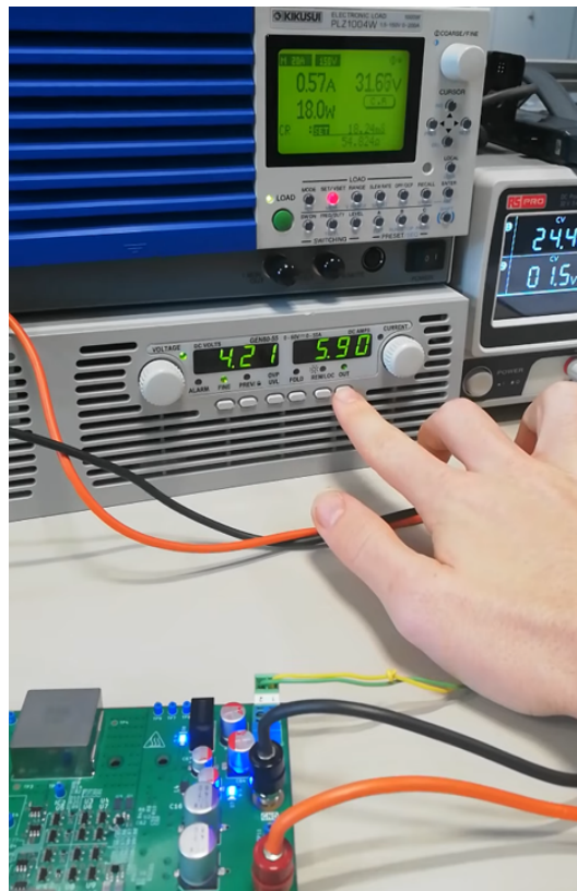
Figura 8.5: Prima prova di funzionamento con 4.2V in ingresso
