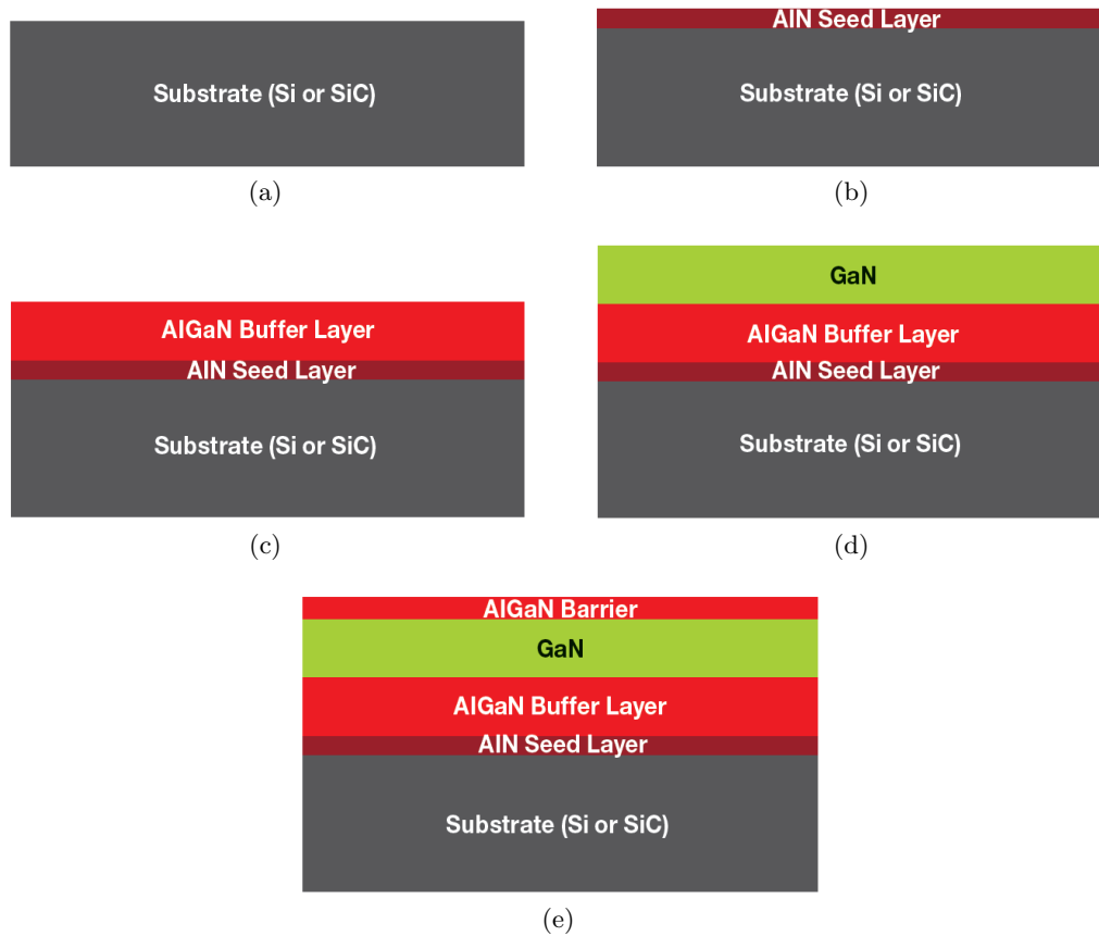
Figura 4.16: Un'illustrazione dei passaggi di base coinvolti nella creazione di una struttura eteroepitassiale di GaN (non in scala).
