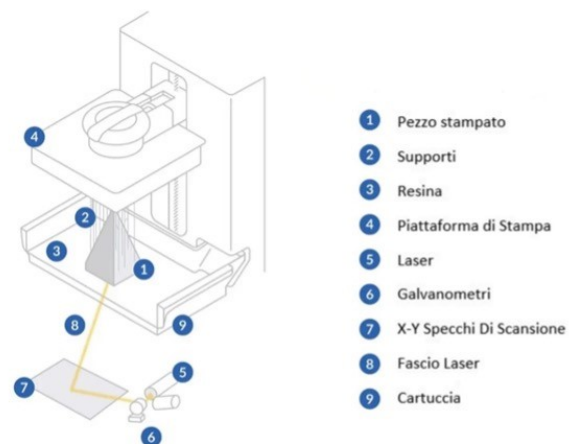
Figura 5, schema funzionamento Form3
