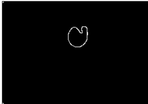
**figura 3.7:** rivelazione del bordo della pupilla con Canny
