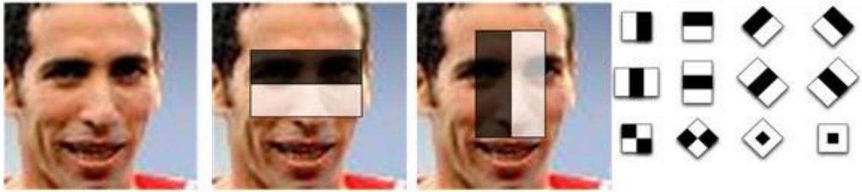
**figura 2.1:** rettangoli individuati sulle parti del volto ed esempi di funzioni rettangolari relative ad una certa finestra di rilevamento
