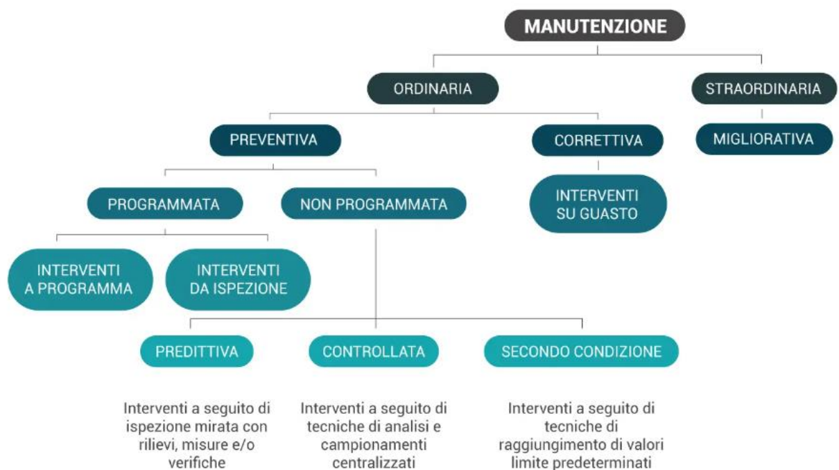
Principali tipologie di manutenzione
