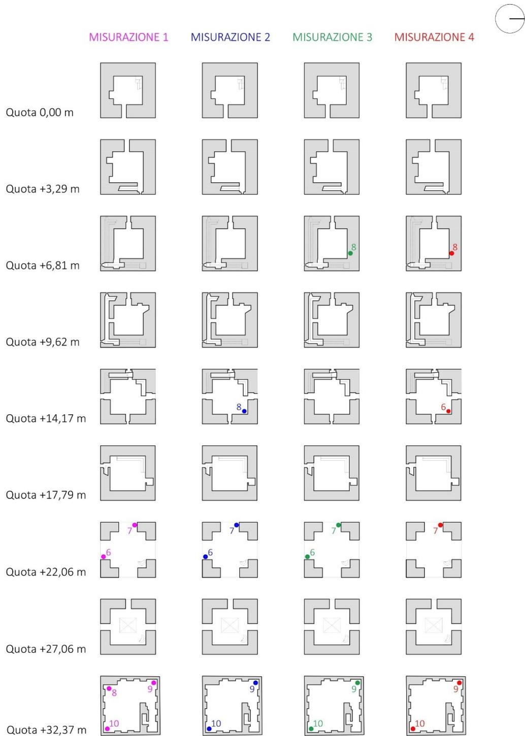
Figura 5.14 - Layout dei sensori in ogni misurazione
