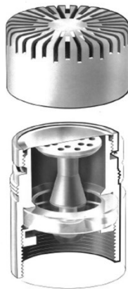
Figura 2. Capsula interna di un microfono a condensatore.
