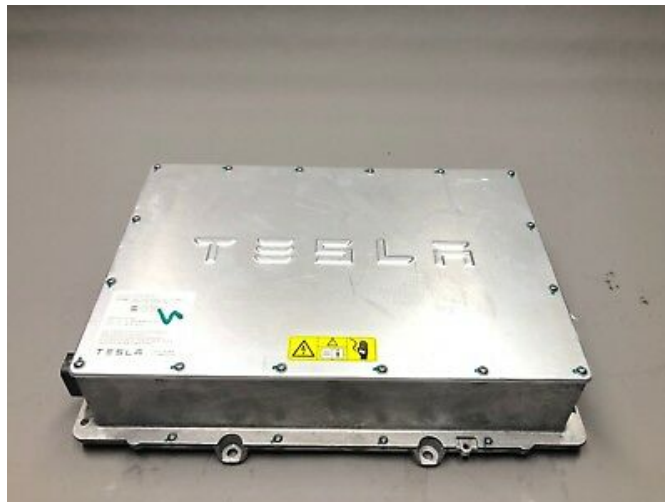
Figura 2.2: On Board Charger di Tesla
