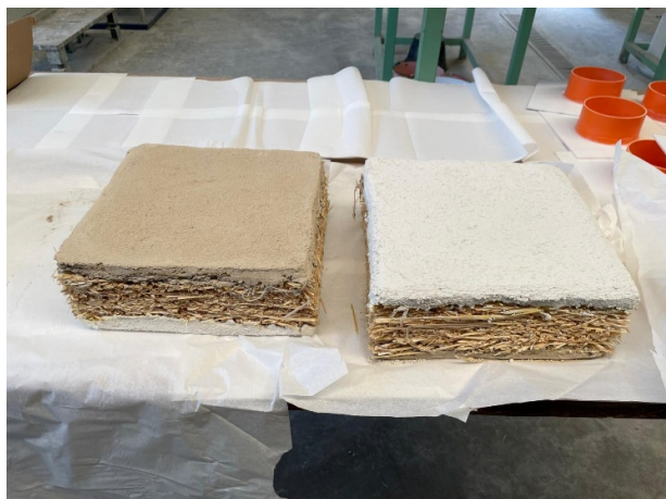
Figura 4.2 - campioni intonacati con malta di terra e malta di calce
