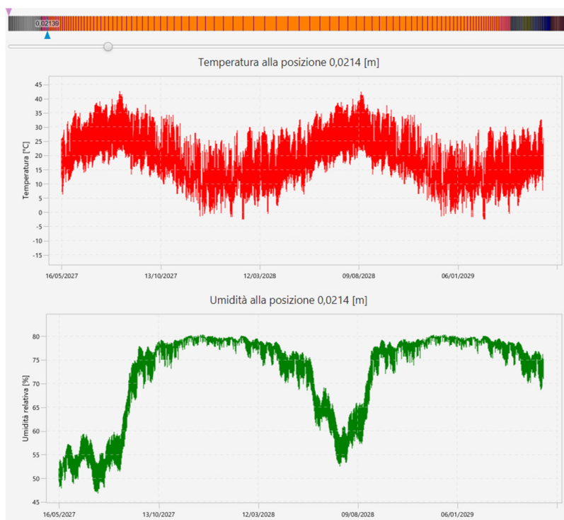
Figura 8.29 - Andamento della temperatura e dell'umidità all'interfaccia Aquapanel - paglia
