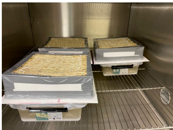
Figura 5.7 - Campioni inseriti nella camera climatica di prova
