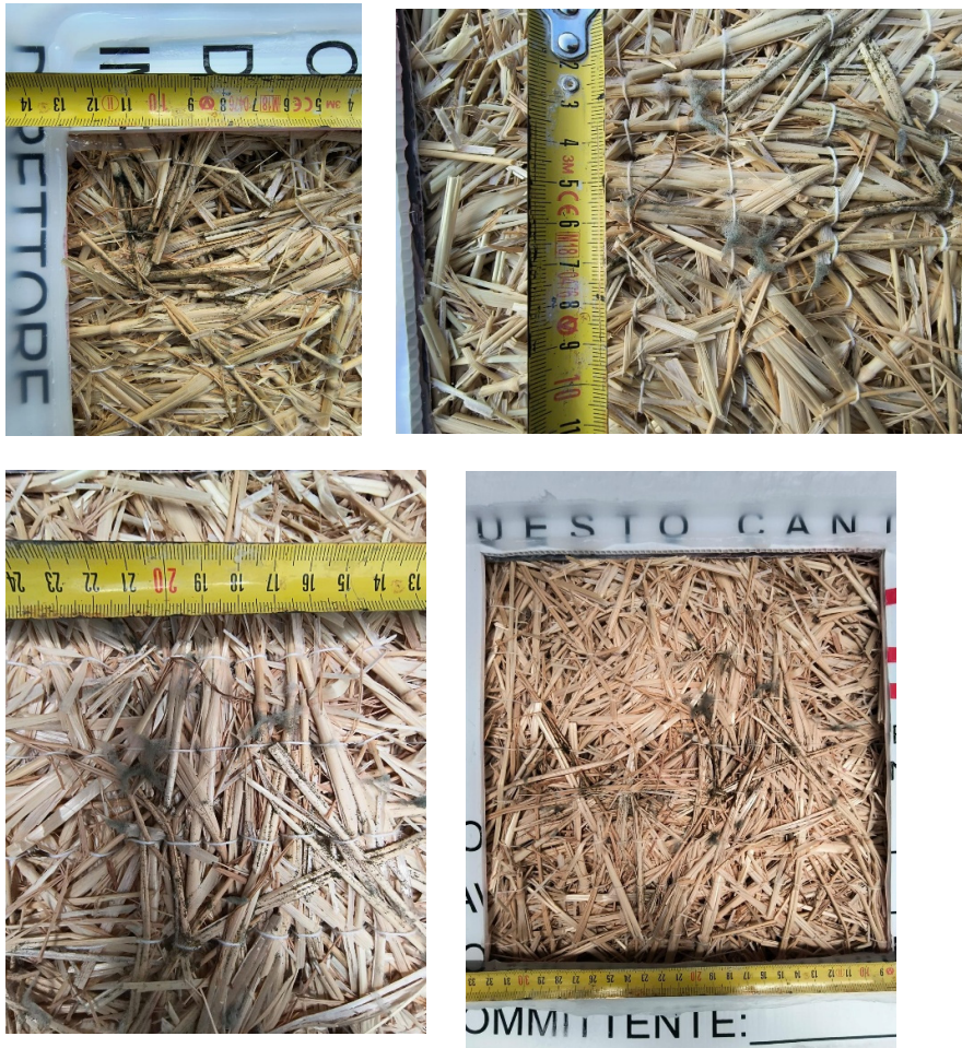
Figura 7.4 - Tracce di muffa osservate sui campioni al termine della prova di permeabilità al vapore acqueo
