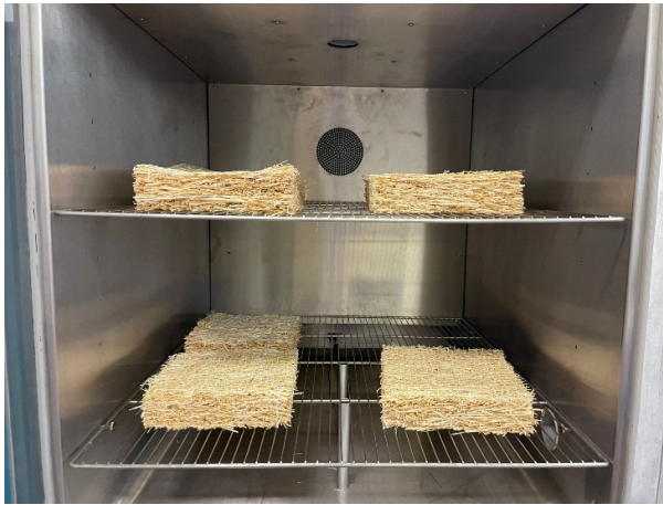
Figura 5.8 - Campioni inseriti nella camera climatica di prova
