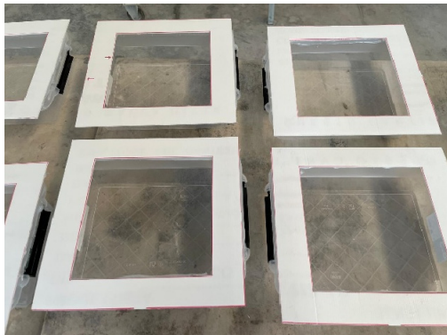
Figura 5.5 - Contenitore in plastica con supporto dotato di apertura 25 x 25 cm
