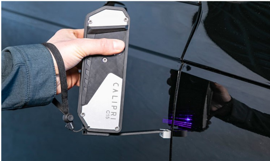
Figura 2.15: dispositivo Calipri della Hexagon per misurare i profili delle autovetture
