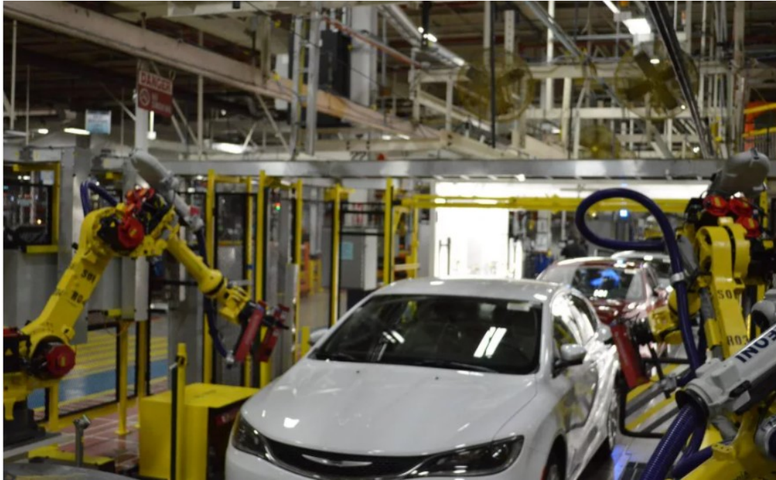
Figura 2.16: robot collaborativi che effettuano misure di Gap e Flush con sistemi Perceptron
