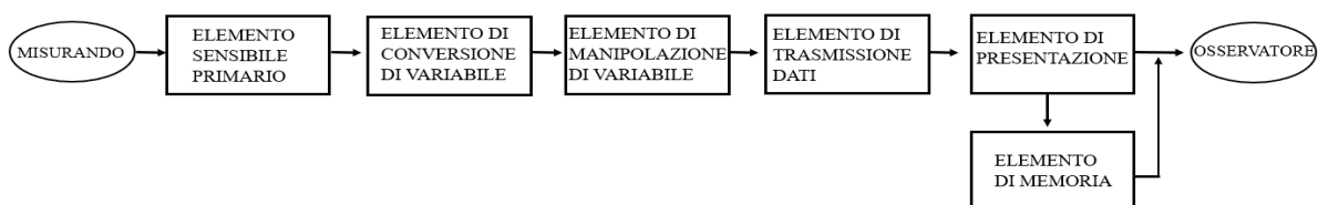
Figura 2.2: schema a blocchi funzionali di uno strumento di misura
