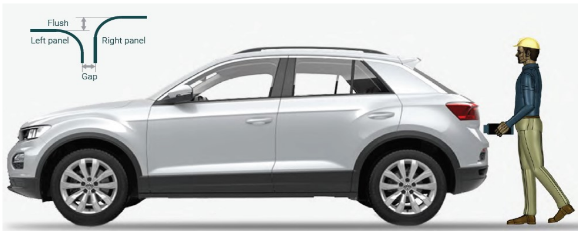
Figura 2.12: l'operatore posiziona ortogonalmente il dispositivo per rilevare Gap e Flush del target di misura
