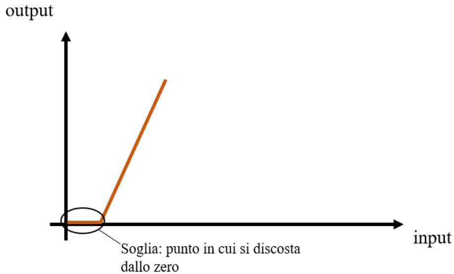
Figura 2.4: diagramma che rappresenta la soglia di uno strumento di misura
