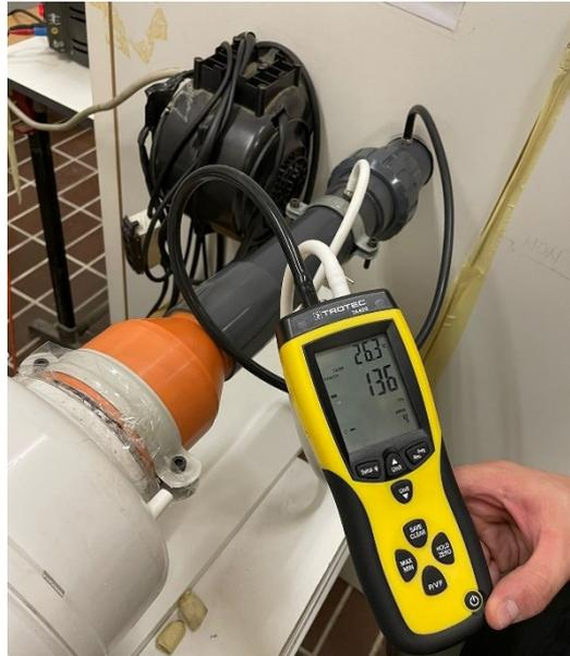
**Figura n. 14** - Manometro Trotec TA400 utilizzato per misurare la pressione differenziale.
