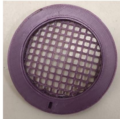
**Figura n. 13** - Supporto del filtro in PLA stampato in 3D.
