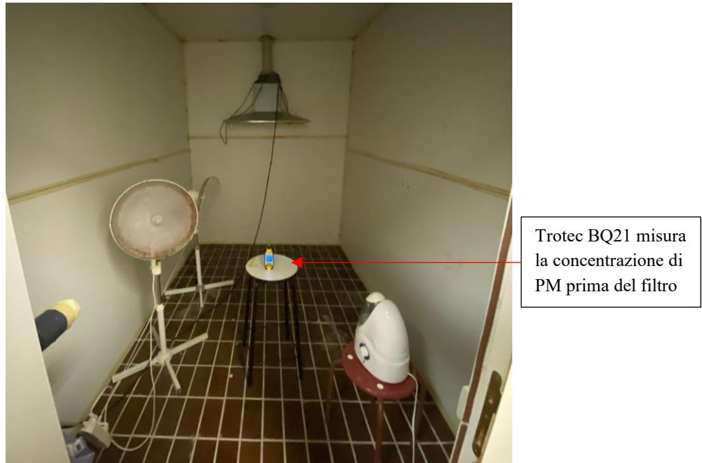
**Figura n. 11** - Allestimento del setup e misurazione della concentrazione di PM prima della filtrazione.
