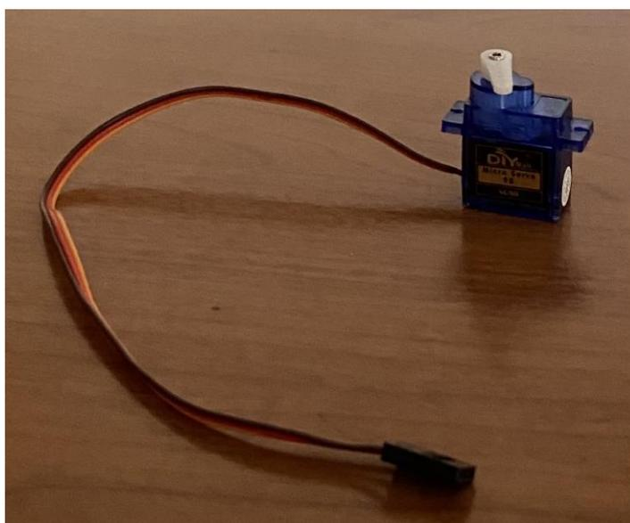
*Figura 2.2. Servomotore utilizzato per muovere il sistema oculare*
