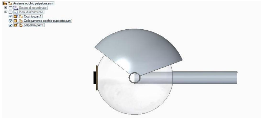
*Figura 3.9. Sistema oculare assemblato*
