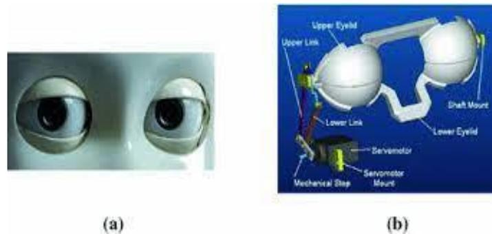
Figura 1.4. a) iCub occhi; b) iCub meccanismo delle palpebre
