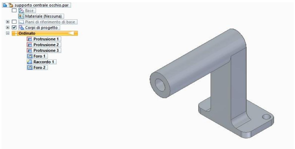
Figura 3.6. Sostegno di supporto
