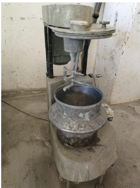
Figura 12. Miscelatore utilizzato per la preparazione della miscela
