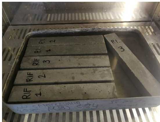
Figura 20. Provini messi a bollire in forno
