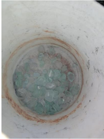
Figura 4. Secchio utilizzato per la frantumazione preliminare del vetro
