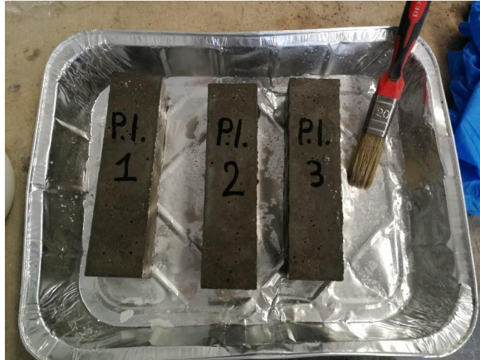
Figura 28. Applicazione del prodotto innovativo con il pennello
