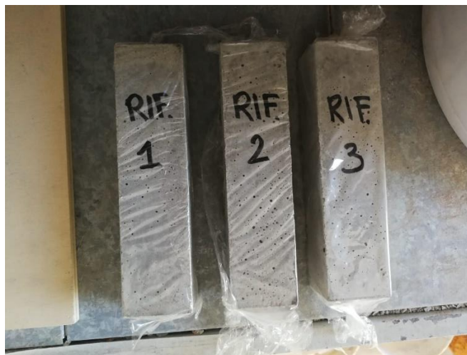
Figura 27. Provini di riferimento scasserati e identificati
