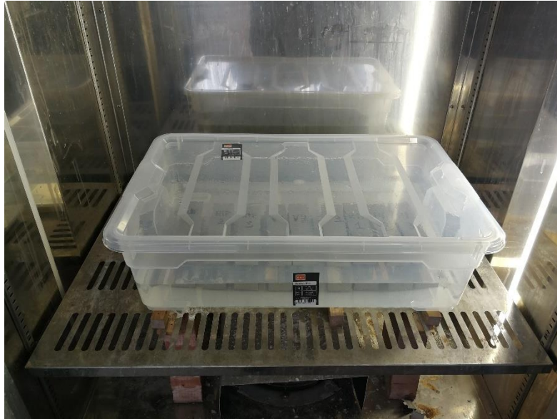
Figura 33. Contenitore sigillato e posizionato nel forno
