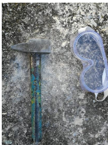
Figura 3. Attrezzatura utilizzata per la preliminare frammentazione di bottiglie e barattoli
