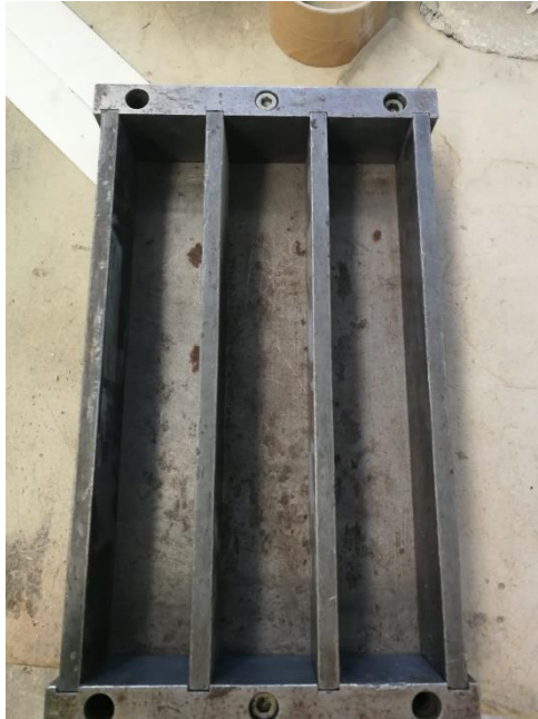
Figura 13. Casseri in acciaio, 5x5x30 cm, utilizzati per il getto della malta
