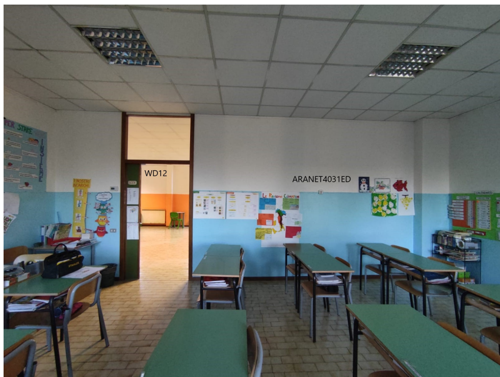
Posizionamento del sensore Aranet4031ED ad un'altezza di 1,60 m e del sensore di apertura WD12
