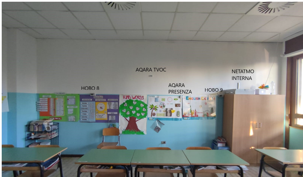
Posizionamento "Hobo 8", "Hobo 9" e "Aqara Presenza" ad un'altezza di 1,60 m e "Aqara TVOC" ad un'altezza di 2,05 m, "Netatmo interna" ad un'altezza di 1,90 m
