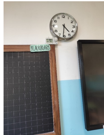
Posizionamento della Hobo 3 ad un'altezza di 1,90 m
