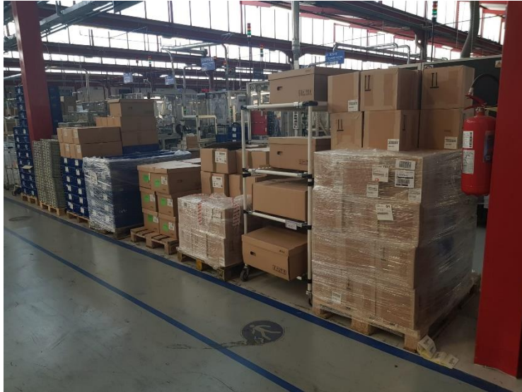
Figura 37. Vie d'uscita non libere ed estintore non facilmente raggiungibile.
