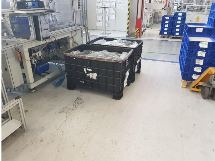
Figura 41. Presenza di materiale in attesa di lavorazione in aree destinate all'accesso e l'uscita.
