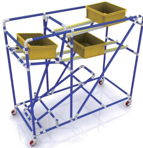
Figura 6. Esempio di sistema Karakuri usato in azienda.
