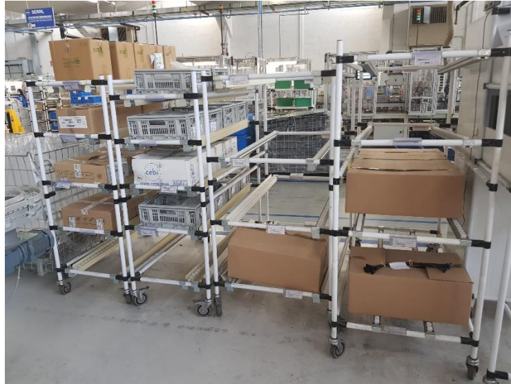
Figura 35. Le rulliere non sono correttamente identificate.
