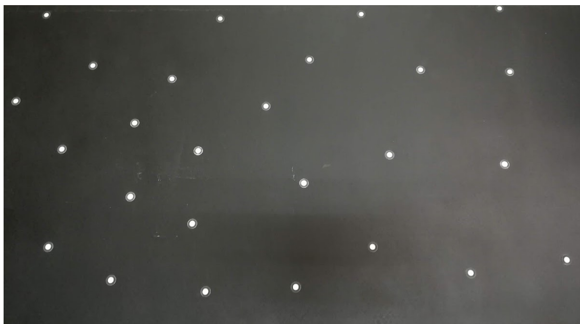
Figura 5.4: Tavola nera, marcata con target bianchi, utilizzata per la calibrazione dello scanner e come piano di appoggio per la scansione dei centrotori
