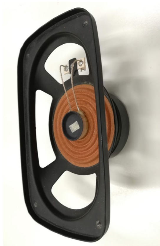
Figura 1.1: A sinistra sezione schematica di un altoparlante, a destra altoparlante parzialmente assemblato con centratore in vista
