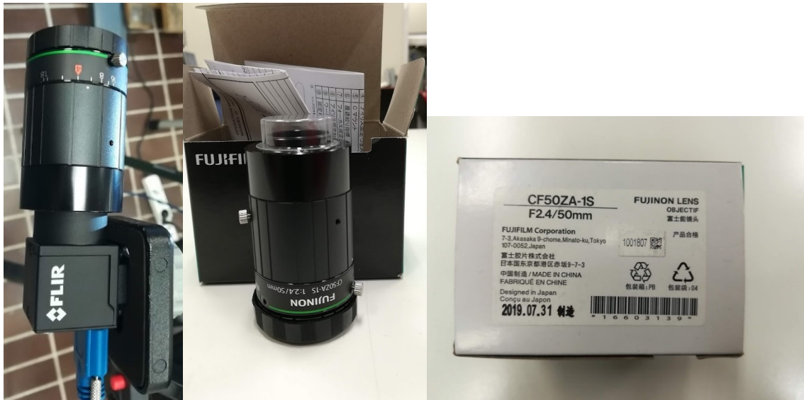
Figura 2.9: A sinistra la telecamera montata sul cavalletto con l'obiettivo da 50mm, al centro particolare dell'obiettivo, a destra caratteristiche tecniche dell'obiettivo
