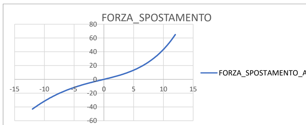
Figura 7.11: Grafico andamento della forza risultante, agente sul cilindro centrale, in funzione dello spostamento per il centratore A
