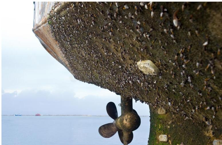
*Figura 2.23 Fouling marino presente sulla carena di un'imbarcazione.*
