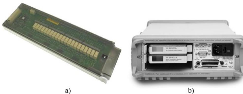
**Figura 3.3** a) Modulo Multiplexer Mod. 34901; b) Slot di inserimento dei moduli all'interno dell'unità di acquisizione dati.
