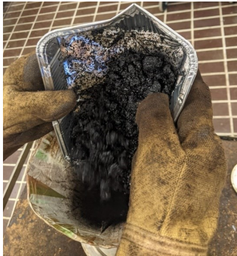
Figura 3.23. Versamento della miscela all'interno della fustella
