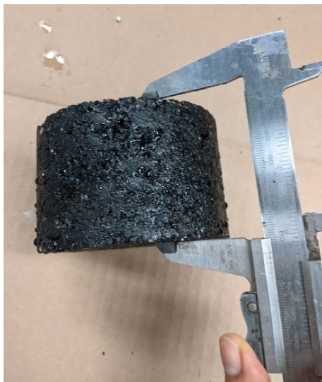
Figura 3.30. Misurazione mediante calibro a cursore
