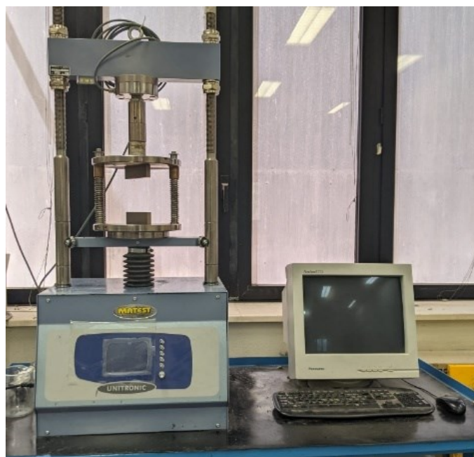
Figura 3.31. Apparecchiatura per prova a trazione indiretta Matest
