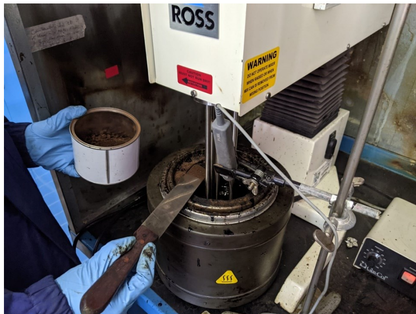
Figura 3.18. Miscelazione lignina e bitume mediante miscelatore Ross
