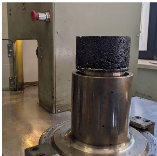
Figura 3.24. Provino confezionato mediante pressa giratoria Pine
