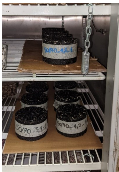
Figura 3.37. Provini condizionati in camera climatica (secondo normativa) ognuno identificato con un codice alfanumerico
