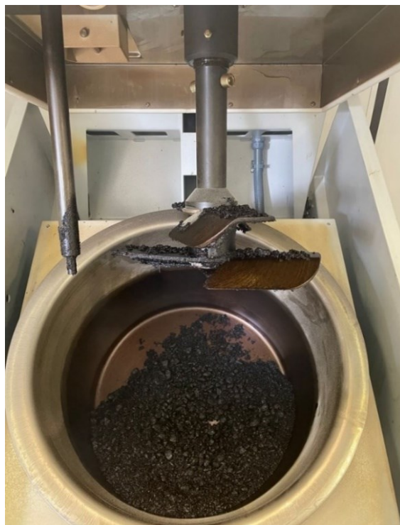
Figura 3.20. Conglomerato bituminoso prodotto mediante miscelatore Infratest
