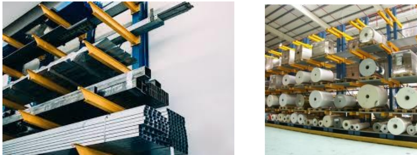
FIGURA 2.3: Stoccaggio di materiali speciali su scaffalatura cantilever.
