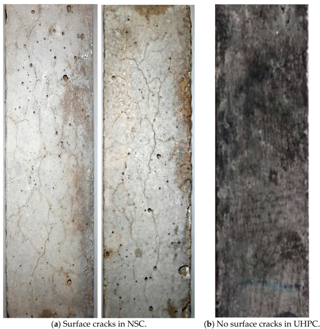
Figura 23 Rotture in NSC e UHPC
