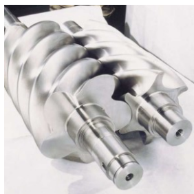
Figura 1-5: Rotori di un compressore a due viti
