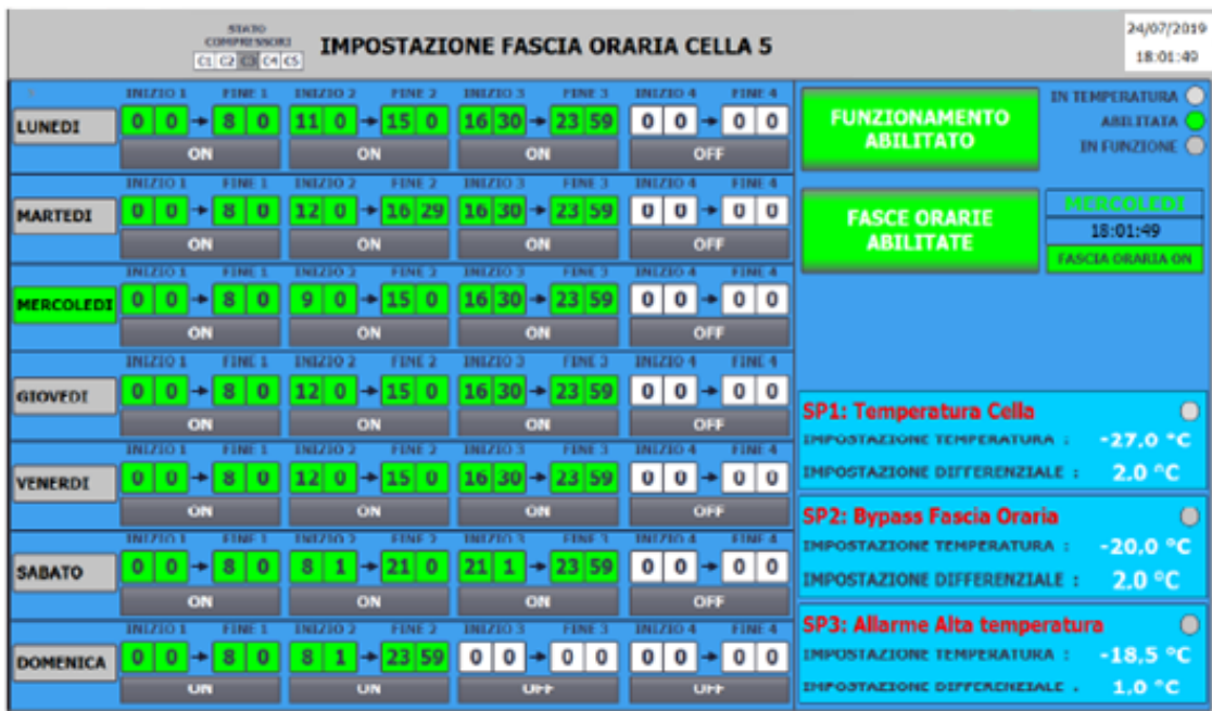
Figura 2-8: Impostazioni fasce orarie di funzionamento
