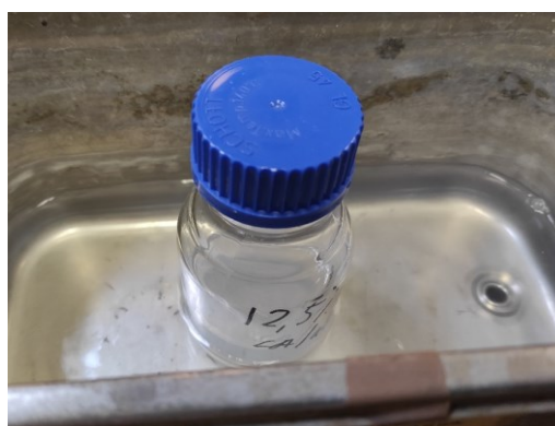
Figura 13: Soluzione 12,5% CA in acetone tratta con ultrasuoni
