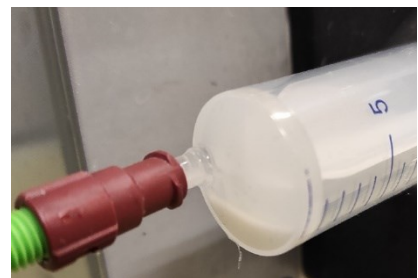
Figura 15: Focus sulla formazione di precipitato per la soluzione 13% PLA + 5% MC in acetone
