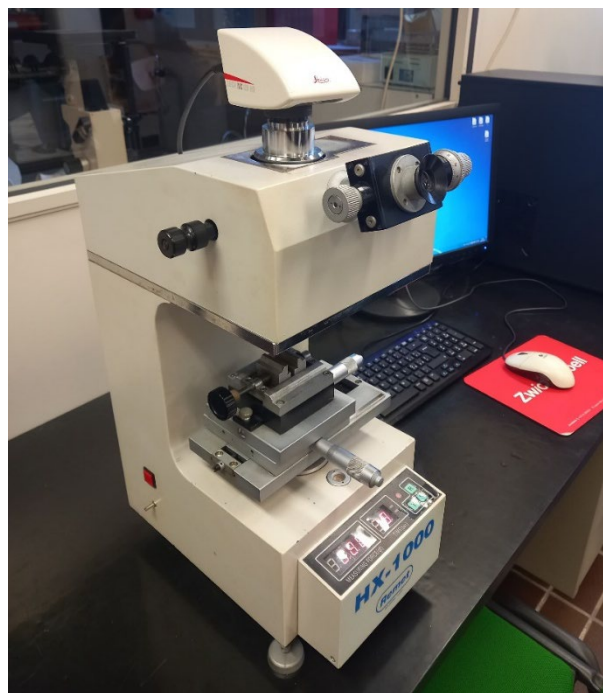
Figura 14: microdurometro Vickers manuale
