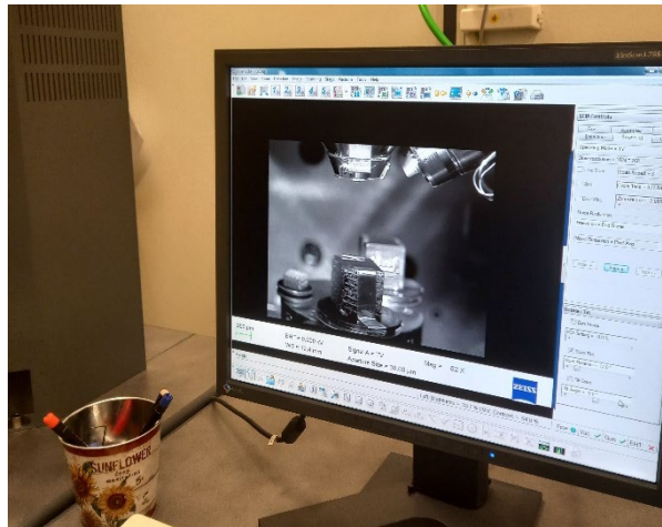
Figura 17: monitor del SEM con visualizzazione in tempo reale dell'interno della camera
