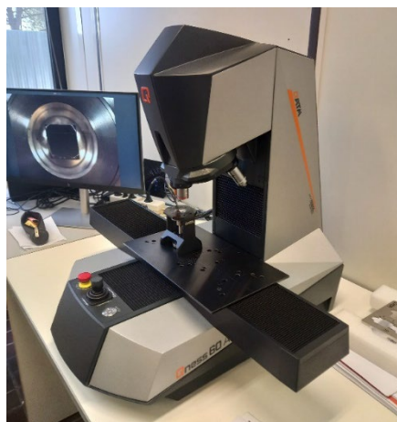
Figura 15: microdurometro Vickers automatico Qness 60 A
