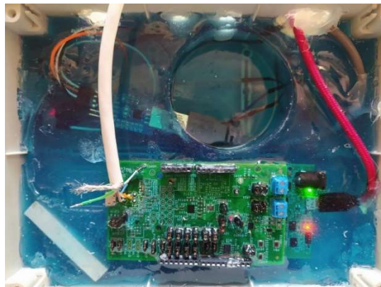
Figura 3 - Scatole elettriche con gel IP68
