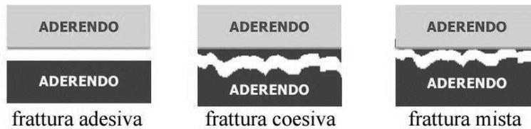
Figura 2.10 - Confronto tra le diverse tipologie di frattura [10]
