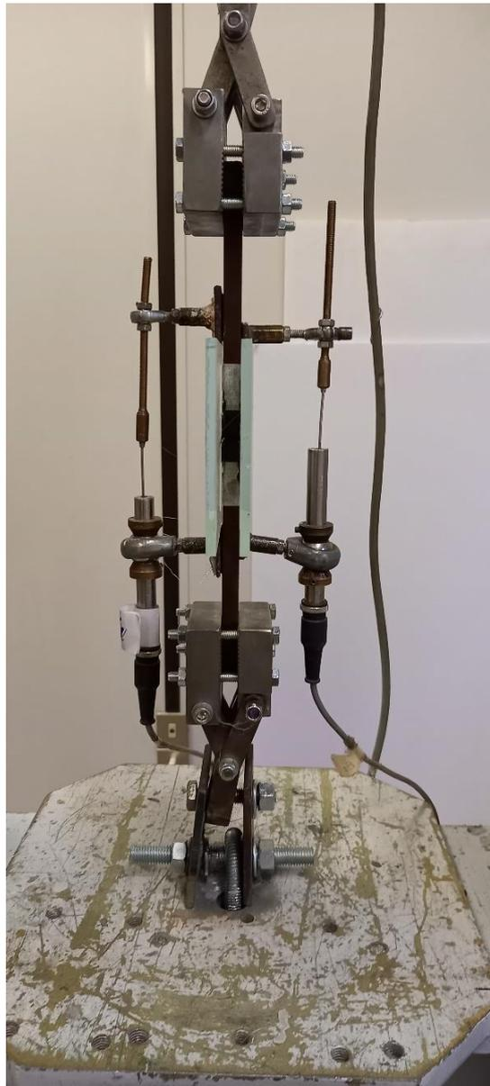
**Figura 4.2 – Test di taglio su giunti double-lap**
