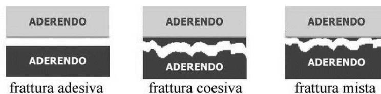
Il cedimento coesivo rappresenta il modo ideale di rottura del giunto; tuttavia, nella realtà, si ha il cedimento misto che viene espresso come percentuale del cedimento coesivo ed adesivo.
