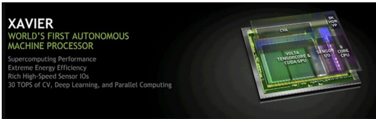
Figura 23: Schema a blocchi SoC Xavier
